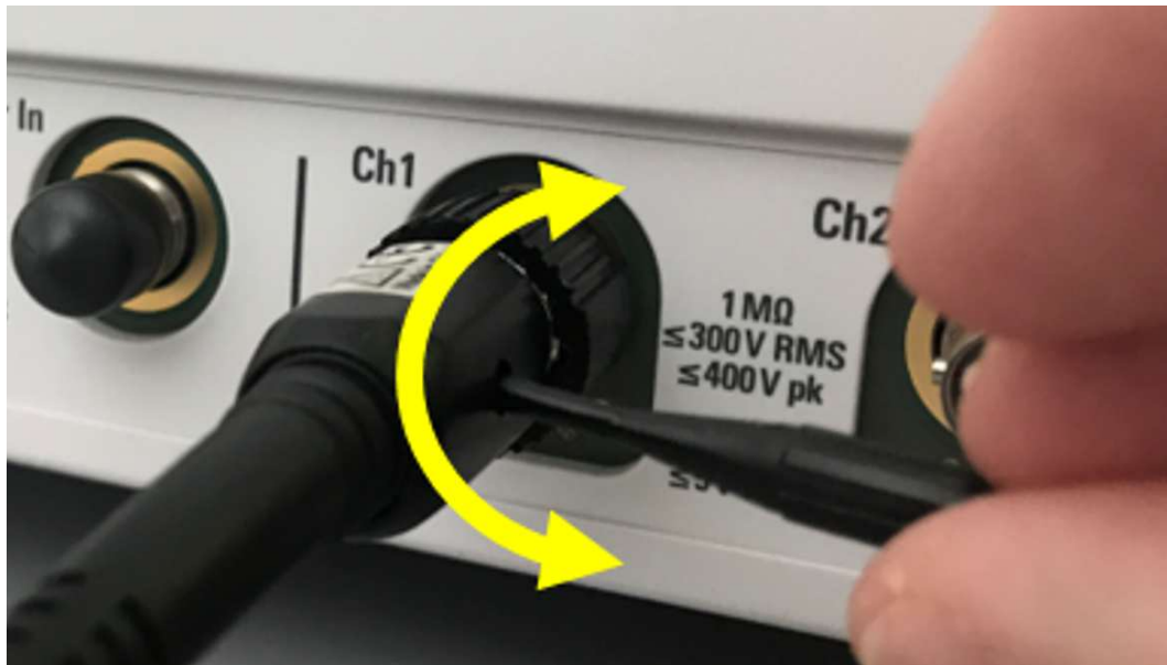
Figura 10: Operazione di compensazione della sonda con un cacciavite antistatico [6].
