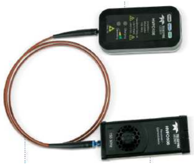
Figura 22: Sonda ad alto voltaggio isolata a fibra ottica Teledyne LeCroy HV-FO108 [44].
