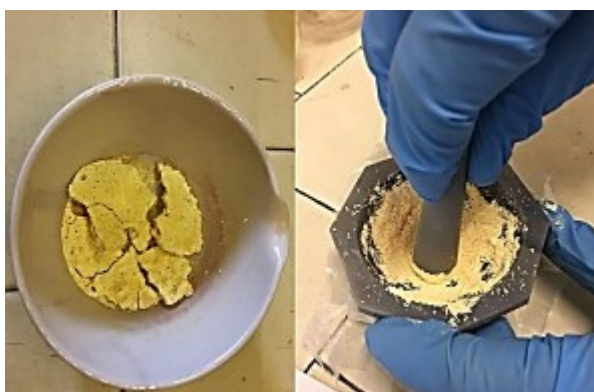
Figura 4.3.1 A sinistra g\text{-C}_3\text{N}_4 dopo muffola / a destra g\text{-C}_3\text{N}_4 ridotto in polvere
