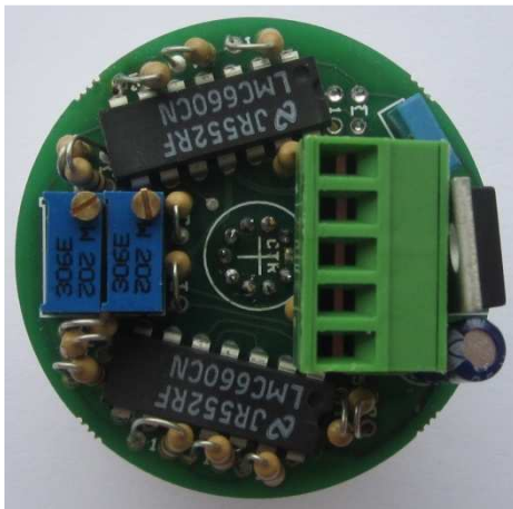
Figura 2.27: Fotografia della scheda elettronica della sonda ottica lato componenti
