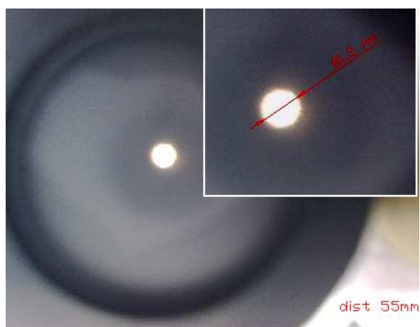
Figura 2.19: Immagine del sole creata dal foro stenopeico e registrata dalla videocamera installata sull'apparecchiatura sperimentale
