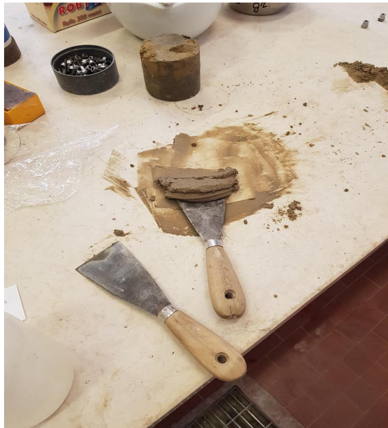
Fig.2.45 - Preparazione del provino vicino allo stato liquido.
