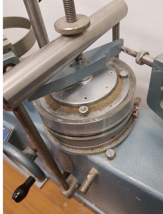
Fig.2.46 e Fig.2.47 - Preparazione del provino all'interno del contenitore ad anello.
