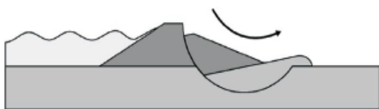
Fig.1.5 (sinistra) – Instabilità rotazionale di tipo profondo del paramento esterno (CIRIA et al., 2013).
