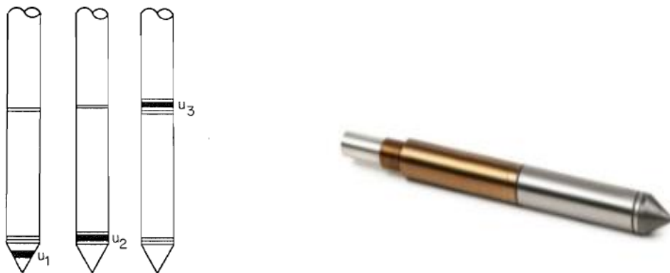
Fig.2.5 (sinistra) – Possibile posizionamento del filtro poroso nelle punte CPTu (Roberson et al., 1998).
