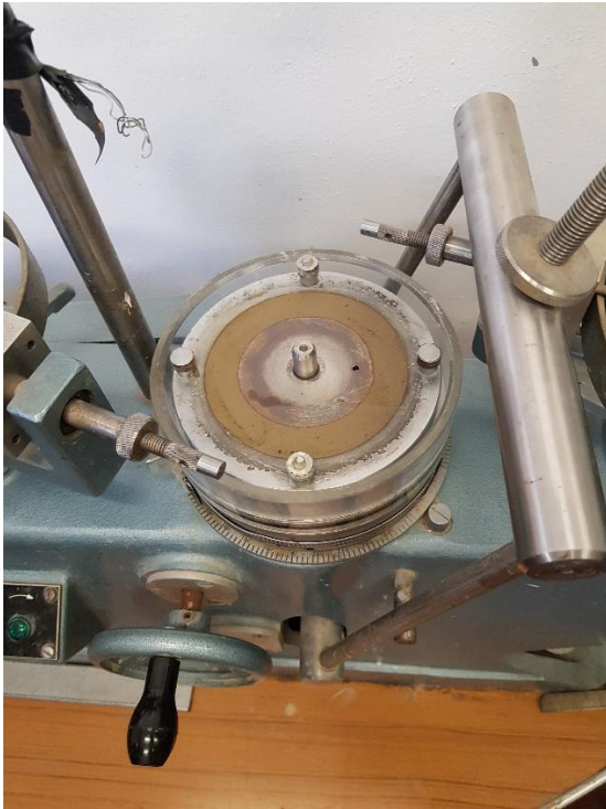
Fig.2.46 e Fig.2.47 - Preparazione del provino all'interno del contenitore ad anello.
