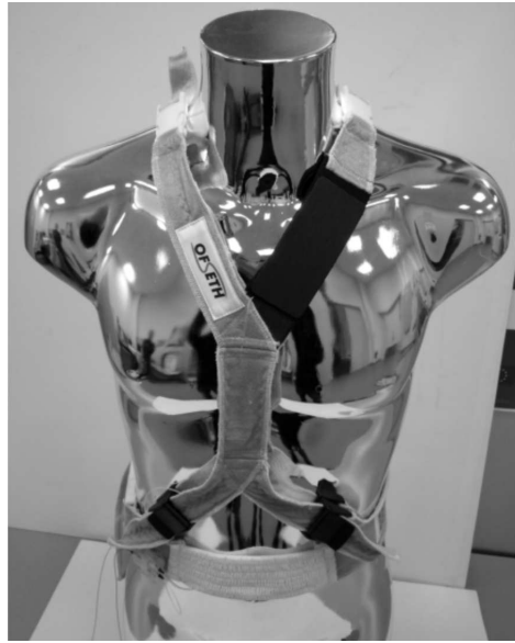
Figura 3.2: Imbracatura per tecniche MRI. I movimenti del torace durante la respirazione sono controllati da un sensore posto nella fascia nera, mentre quelli addominali da un sensore posto nella fascia bianca [12] .
