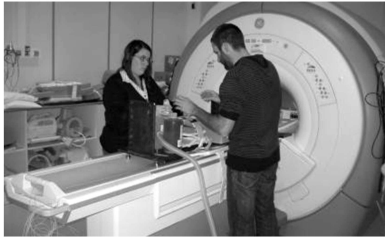
Figura 3.6: Ambiente simulato di MRI, in cui il paziente è stato sostituito da un palloncino e un macchinario per simulare l'atto respiratorio [12] .
