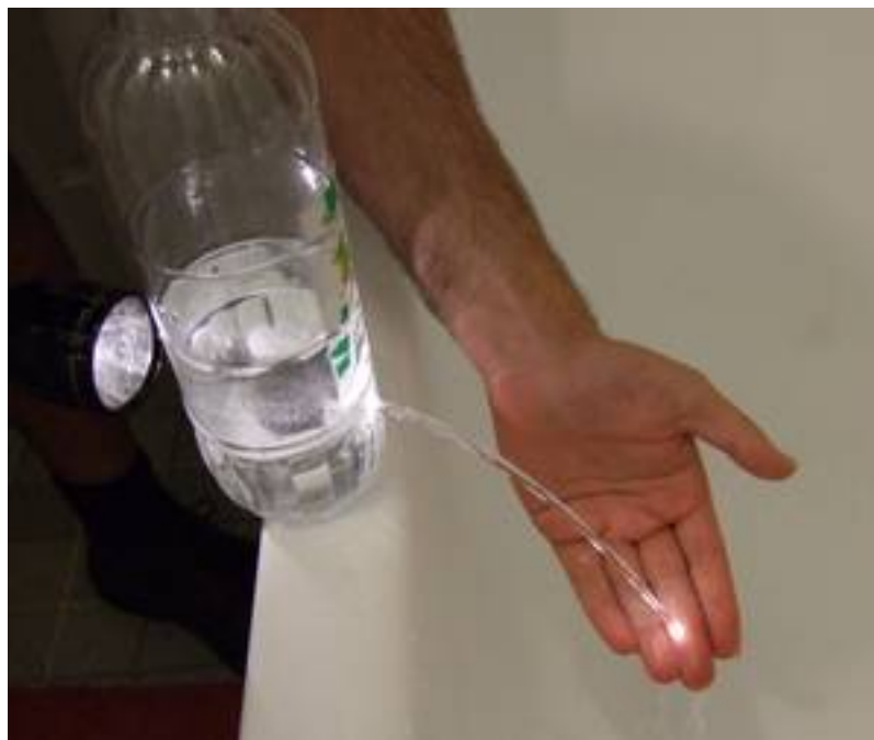
Figura 2.1: Esperimento semplice, ma efficace, che dimostra come la luce può essere guidata tramite un mezzo, in questo caso acqua [30] .
