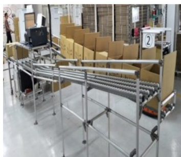
Fig. 5.15 Rack di flusso Karakuri per la movimentazione dei cartoni (Fonte: Chang e Lai, 2023)
