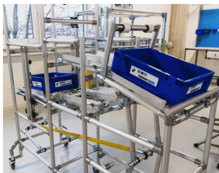
Fig. 4.15 Esempio di rastrelliera basculante FIFO realizzata mediante l'approccio Karakuri Kaizen (Fonte: Beewatec, 2024)
