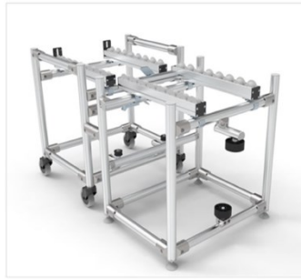
Fig. 5.12 Esempio in commercio di dispositivo Karakuri a rilascio laterale integrabile su AGV (Fonte: Item, 2024)
