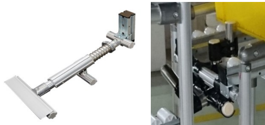
Fig. 5.10 Rappresentazione rispettivamente del sensore di pressione e del modulo di liberazione del prodotto finito (Fonte: Chang e Lai, 2022)
