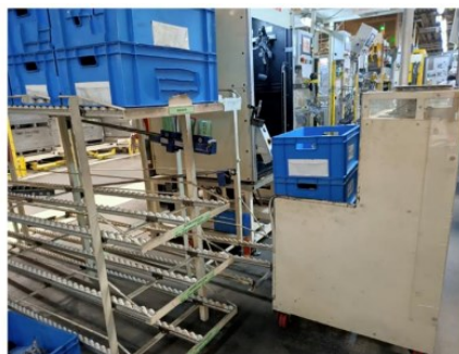
Fig. 5.22 Esempio di allineamento del carrello Karakuri alla scaffalatura A (Fonte: Özcan, 2022)
