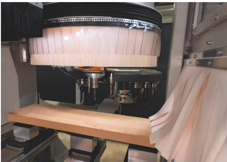
Fig. 5.7 – A lato la fase in cui il centro di lavoro seleziona automaticamente l'utensile più adatto per eseguire la lavorazione. In alto i vari utensili selezionabili
