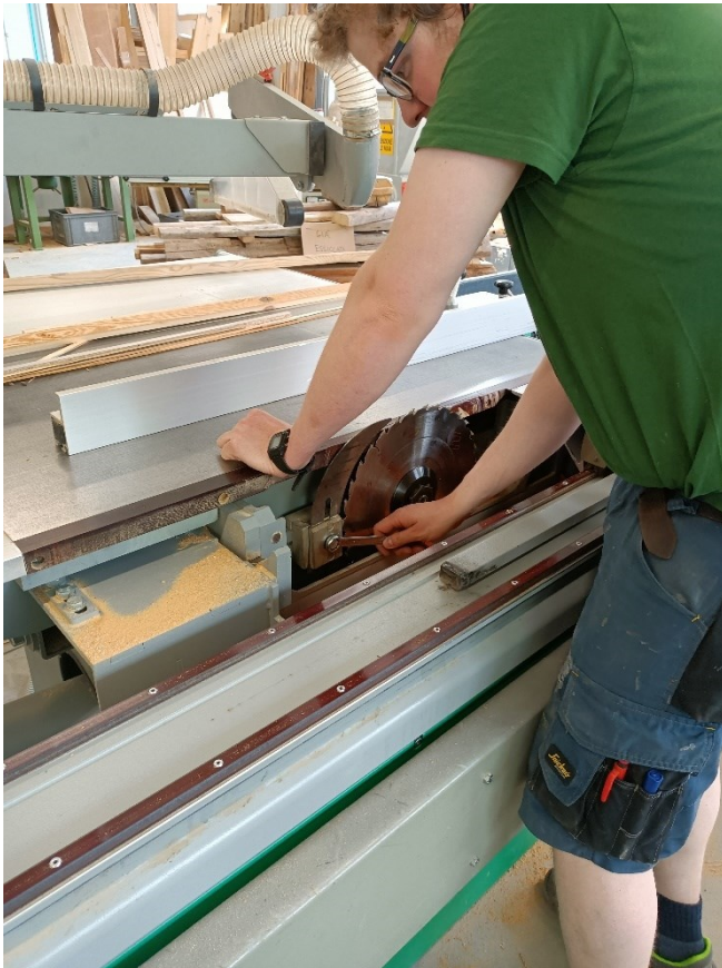
Fig. 5.6 – A lato il falegname mentre cambia il disco della squadratrice.
