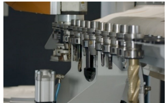
Fig. 5.7 – A lato la fase in cui il centro di lavoro seleziona automaticamente l'utensile più adatto per eseguire la lavorazione. In alto i vari utensili selezionabili
