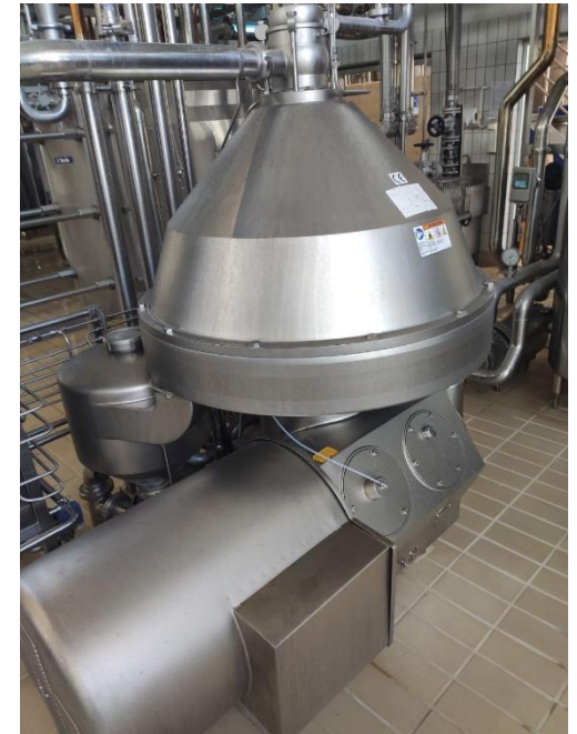
Separatore centrifugo (scrematrice) usata in azienda
