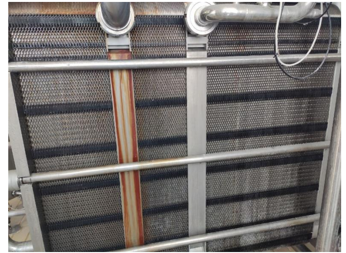
Scambiatore di calore a piastre usato in azienda
