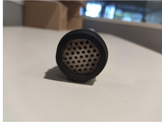
Membrana di ceramica del microfiltratore in azienda
