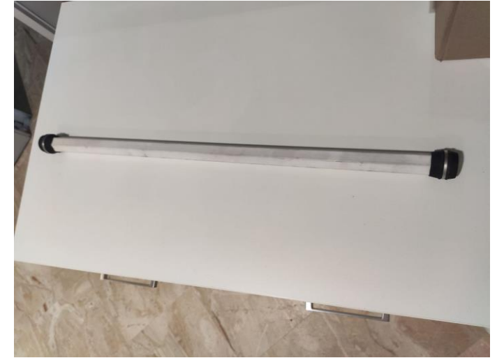
Membrana di ceramica del microfiltratore in azienda
