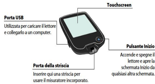
Figura 4.6: principali caratteristiche lettore Freestyle Libre (Fonte: Manuale FreeStyle)
