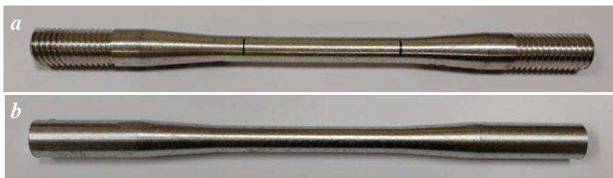
Figura 2.7: Provini lavorati a) per le prove a trazione a caldo, b) per le prove a fatica e a trazione a temperatura ambiente
