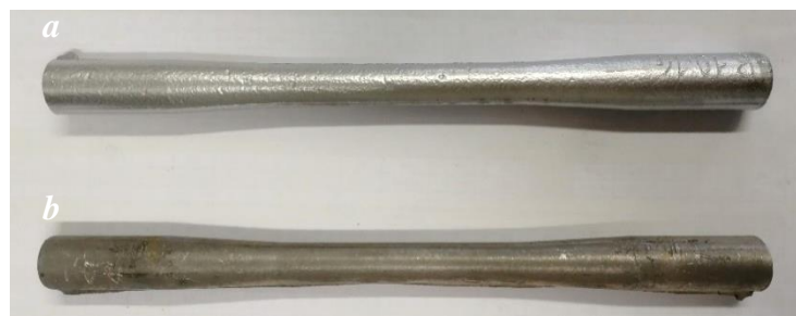
Figura 2.4: Provino grezzo a) prima e b) dopo trattamento termico
