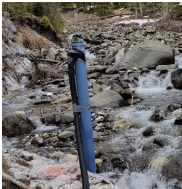
Figura 14 Disposizione tubo protettivo con Levellogger e Barologger all'interno (Martin, 2021)
