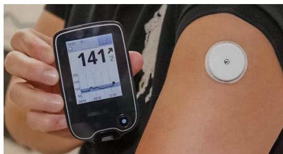
Figura 1: Sensore sottocutaneo per CGM
