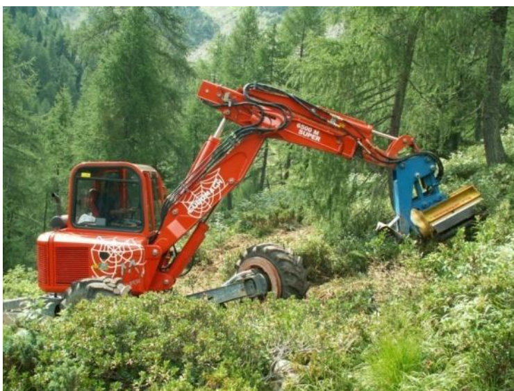
Fig. 1.3 L'escavatore tipo "ragno" Euromach 6500 dotato di testata tipo trincia forestale Seppi M. BMS-L in azione.
