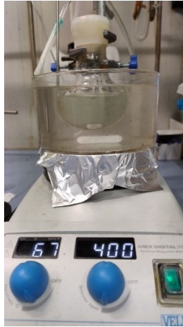
Figura 3.1. Setup per la sintesi del macroiniziatore PAN-Br.
