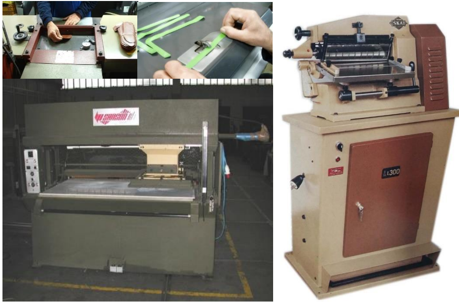
Figura 22 – Diversi macchinari per la trancia [Atom] [Skat] [Sanson]
