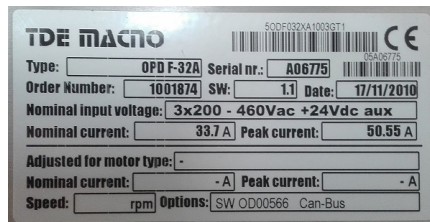
(b) Dati di targa dell'inverter
