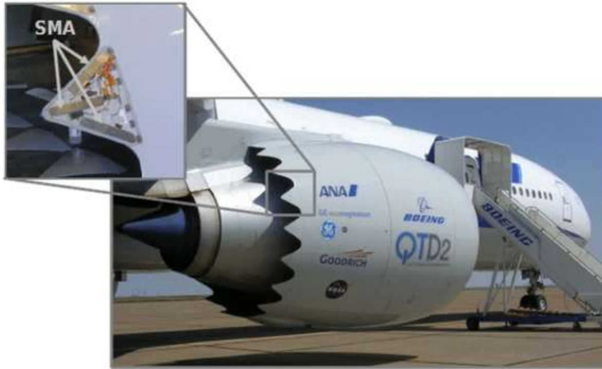
Figura 10: Chevron a geometria variabile su Boeing 777-300ER
