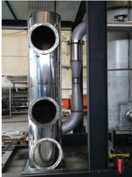
Figura 9, scrubber venturi e torri di lavaggio
