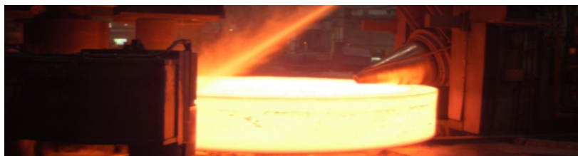
Figura 6: laminazione di un anello in titanio (Forgital Italy S.p.a.): www.forgital.com
