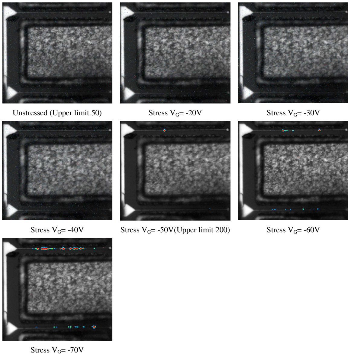
Figura 9.17: Emissioni in OFF-state del dispositivo A3_h4-PCM (wafer SLX NC-03)
