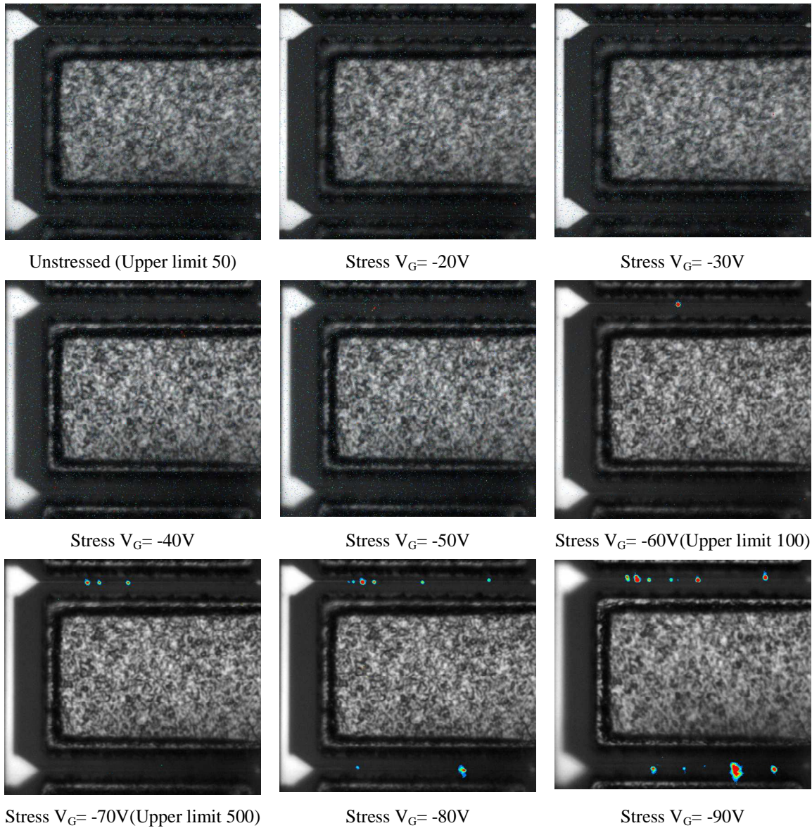
Figura 9.13: Emissioni in OFF-state del dispositivo D3_h4-PCM (wafer SLX IA-01)
