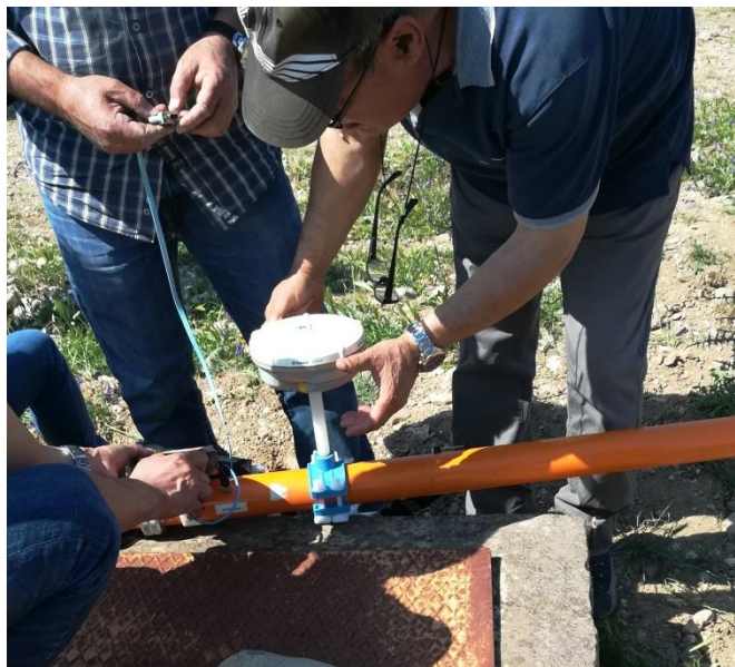
Figura 34: Elettromagnetometro a induzione CMD Explorer della Gf Instruments utilizzato per le misure EM a Decimomannu.
