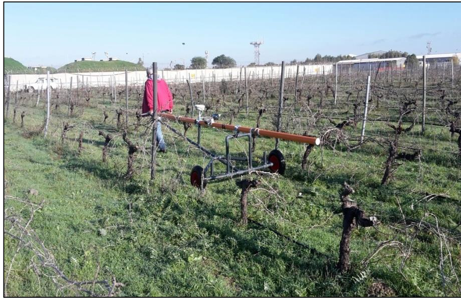
Figura 39: Misure EM realizzate nella vigna con l'elettromagnetometro a induzione CMD Explorer.
