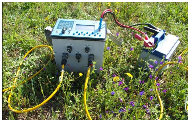
Figura 31: Resistivimetro IRIS Syscal Pro 72 utilizzato per le misure ERT a Decimomannu.
