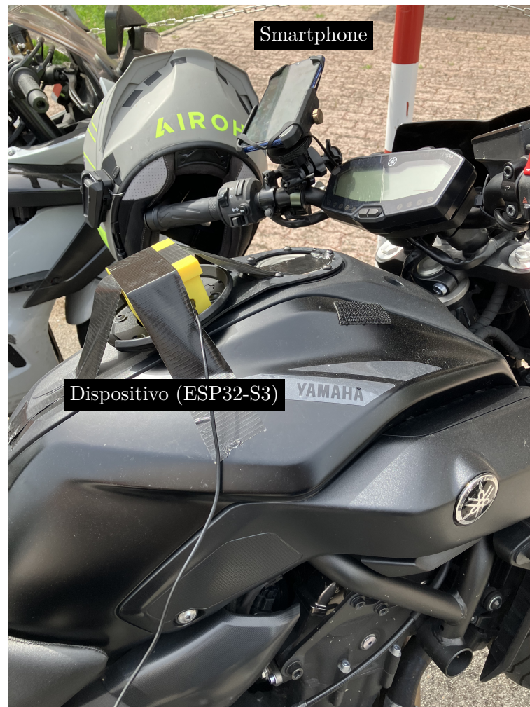
Figura 5.1: Posizionamento del dispositivo e dello smartphone sulla moto.
