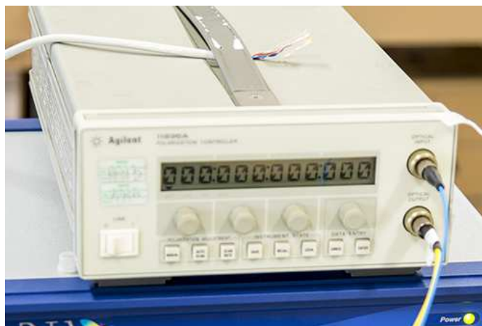
Figura 4.6: Controllore di polarizzaione
