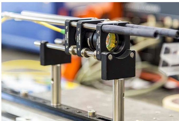
Figura 4.3: Fotografia dell'allineamento tra fibra ottica e lenti
