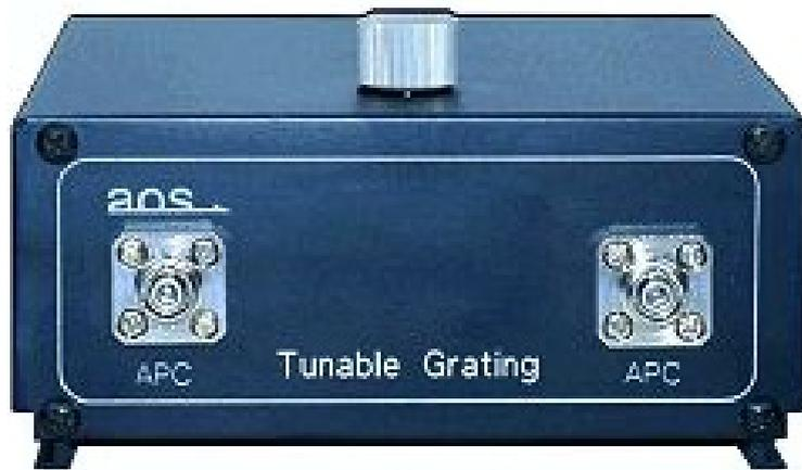
Figura A.1: Filtro FBG sintonizzabile utilizzato negli esperimenti.
