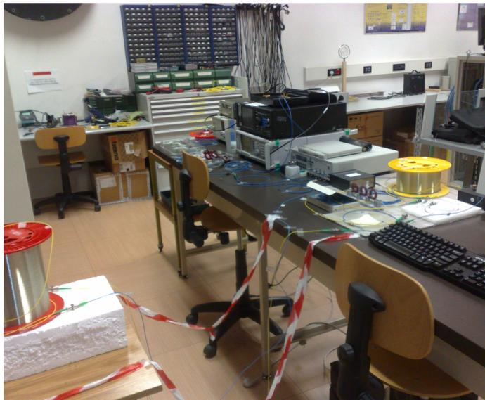
Figura 3.12: Banco di prova: nella parte sinistra è visibile la fibra sensore utilizzata, mentre nella parte destra si possono osservare i vari componenti dello schema finale.
