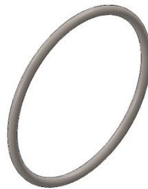
Figura 7.2.5.1: O-Ring ISO 3601 - G - 65x3,55 relativo al tappo flangiato d'ispezione dell'albero d'ingresso
