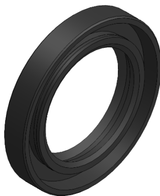
Figura 7.2.5.4: Anello di tenuta a labbro DIN 3760 - AS 30x47x7 - NBR – GK da [7]
