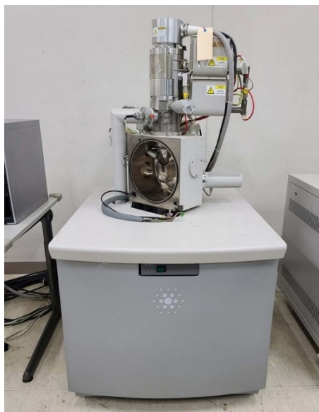
Figure 26: Quanta 200 SEM (Thermo Fisher Scientific, Eindhoven, Paesi Bassi) (XXII)
