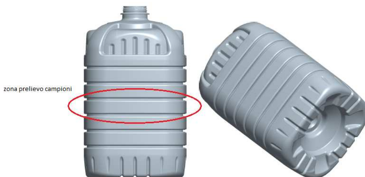
Figura 5.4 Viste 3D del contenitore con dettaglio della zona di selezione dei campioni per DMA , DSC e densità.
