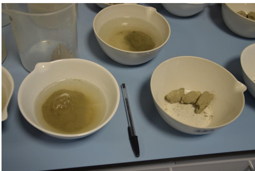
Figura 5.1- Campione in ciotole di ceramica. A destra il campione ha appena terminato il primo ciclo in forno ad una temperatura di 50°C per circa 12 ore, mentre al campione a sinistra è stata aggiunta acqua cada successivamente al ciclo in forno.
