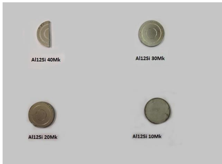
Figura 7 – Campioni ottenuti in argon con processo in umido
