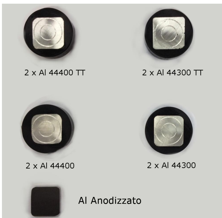
Figura 10 – Campioni di lega Al 44400 T.T. (trattato termicamente) in alto a sinistra; campioni di lega Al 44300 TT in alto a destra; campioni di lega Al 44400 in centro a sinistra; campioni di lega Al 44300 in centro a destra; campione di Al anodizzato in basso a sinistra
