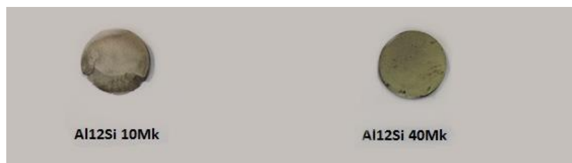
Figura 9 – Campioni ottenuti in argon con processo a secco
