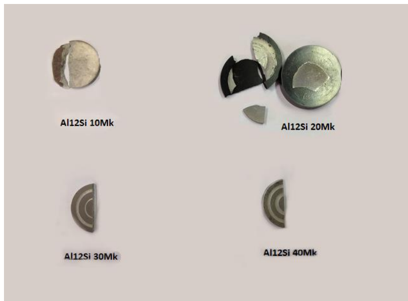
Figura 8 – Campioni ottenuti in azoto con processo in umido
