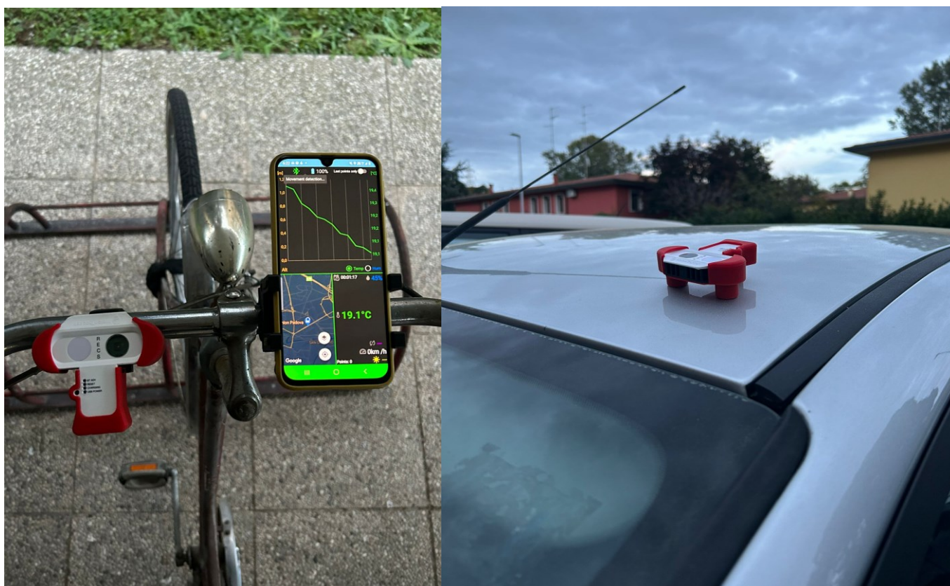
Figura 5. Foto della stazione MeteoTracker ® in funzione e applicazione per la visualizzazione in tempo reale su mappa, grafici ed in formato numerico delle misurazioni.
