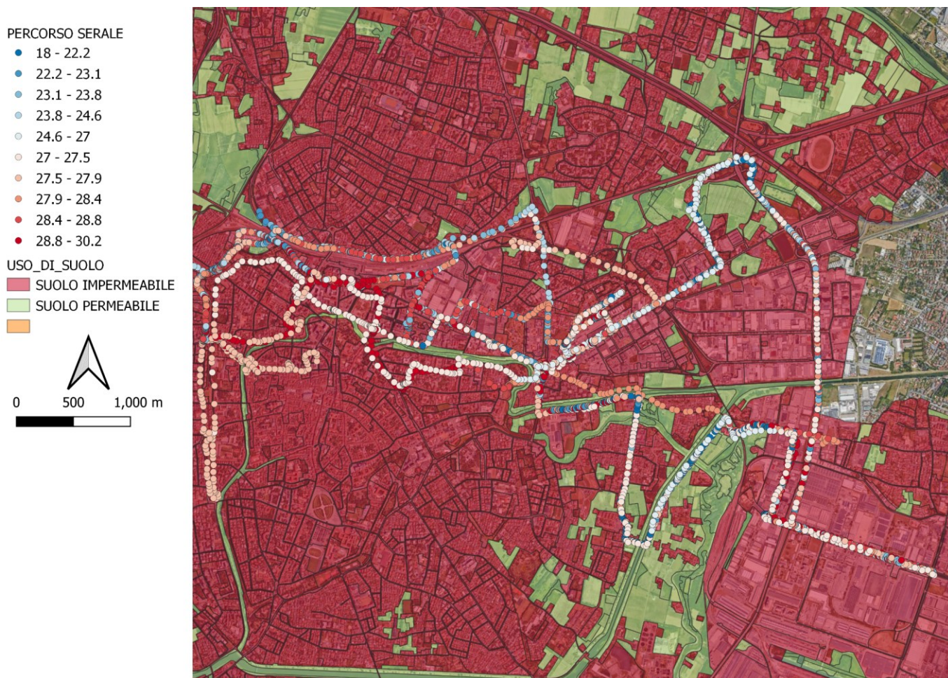
Figura 35. Percorsi serali dal 24 agosto al 11 settembre 2023, i valori di temperatura dell'aria [°C] a confronto con la Carta di Consumo del Suolo.
