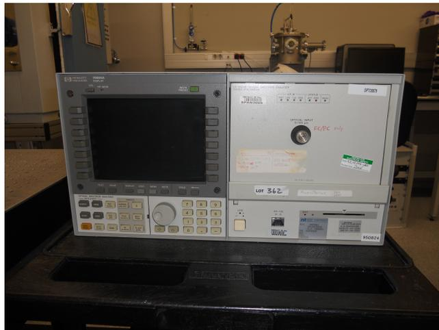
**Figura 3.5:** Analizzatore di spettro ottico
