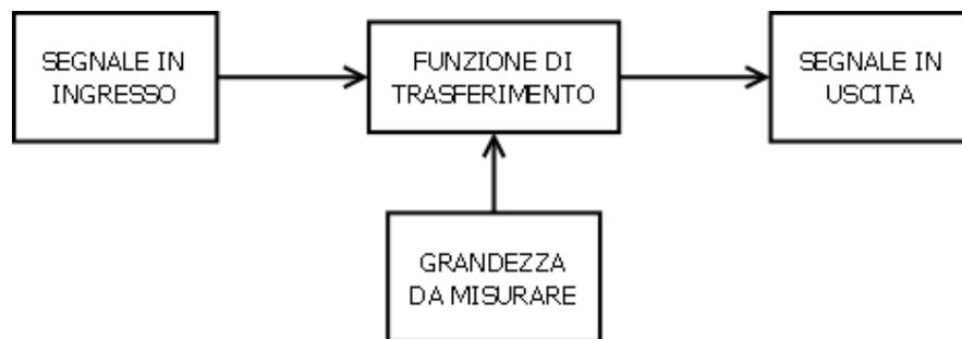
Figura 1.3: Schema a blocchi di un sensore fotonico
