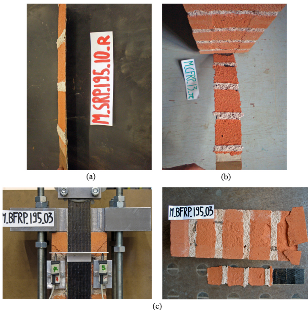
Figura 5.64: Prove di adesione su murature: esempi di rotture riscontrate.
