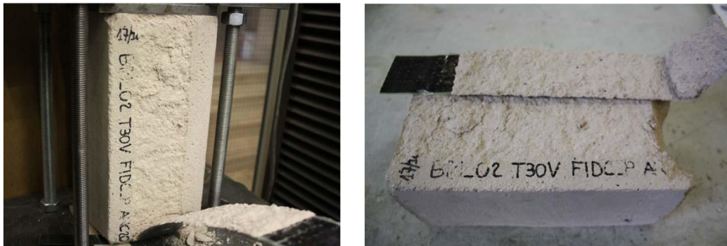
Figura 72: Campione Malta-C-05: campione dopo la rottura.
