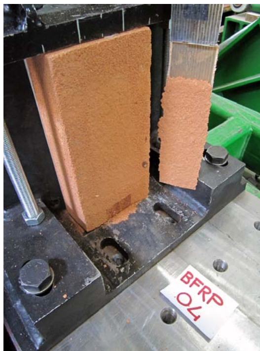
Figura 46: Campione SL-Basalt-04: campione dopo la rottura.
