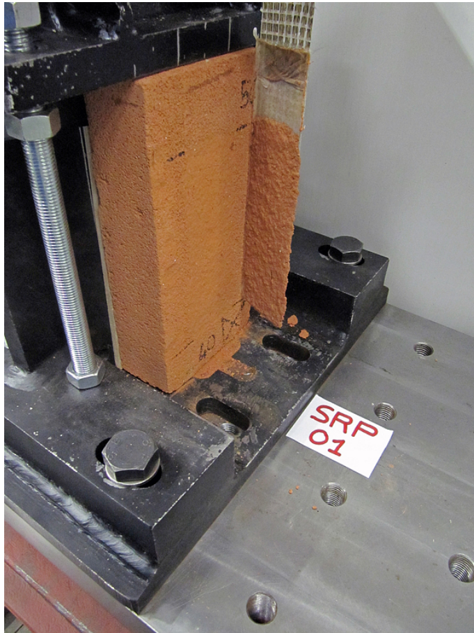
Figura 5.17: Campione SL-Steel-01: campione dopo la rottura.
