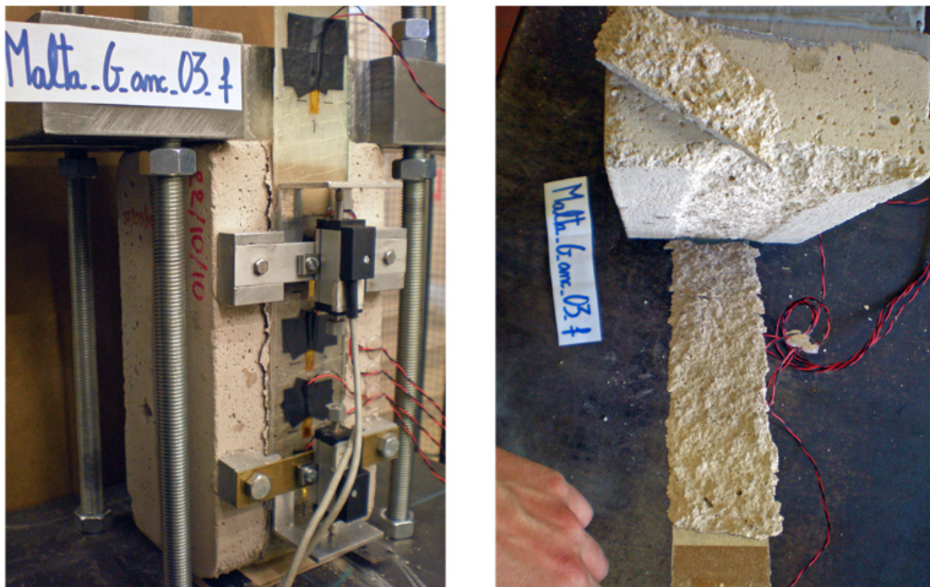
Figura 66: Campione Malta-G-03f: campione dopo la rottura.
