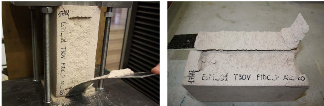
Figura 69: Campione Malta-C-01: campione dopo la rottura.
