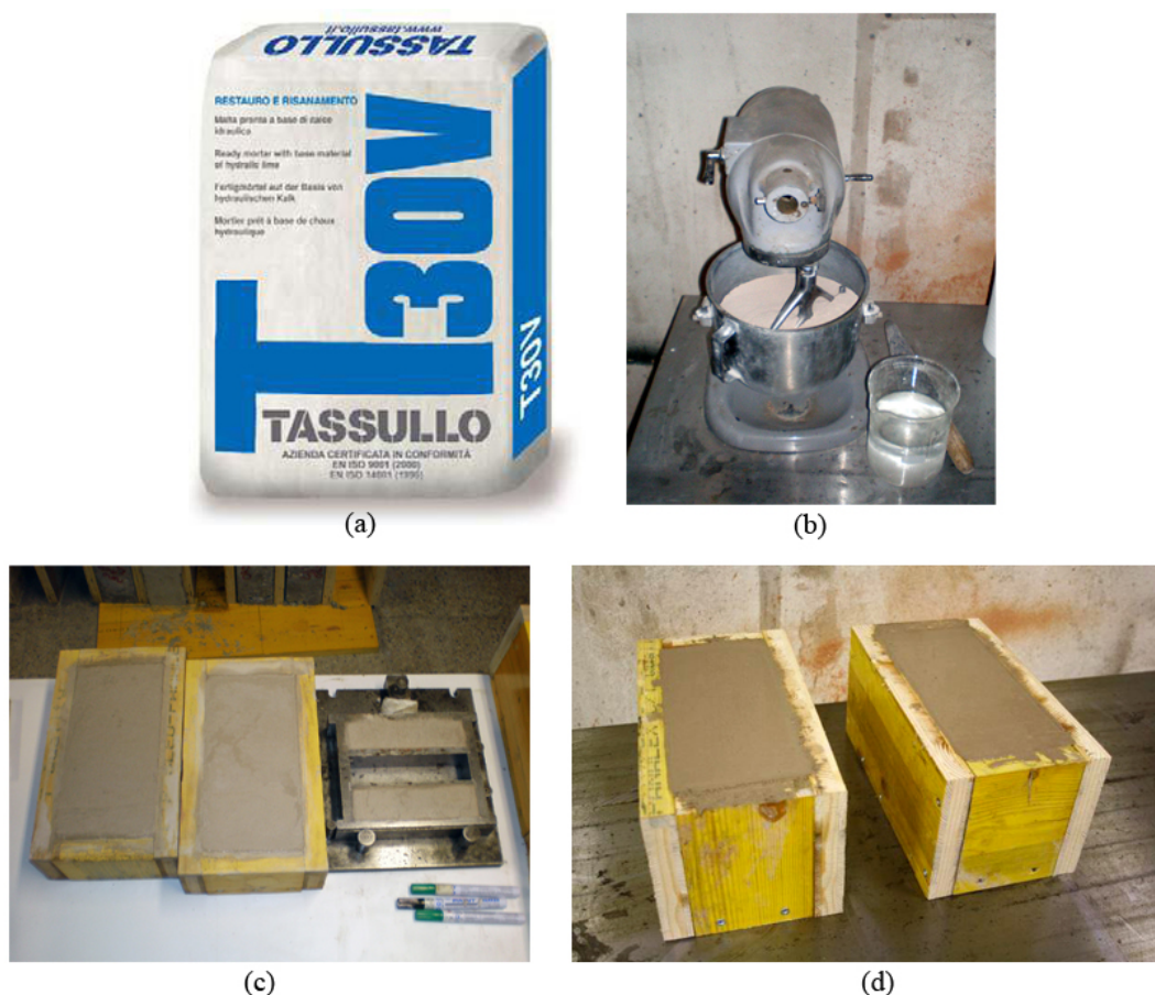
Figura 3.2: Preparazione dei provini in malta: (a) malta utilizzata, (b) miscelatrice, (c)-(d) casseri utilizzati.
