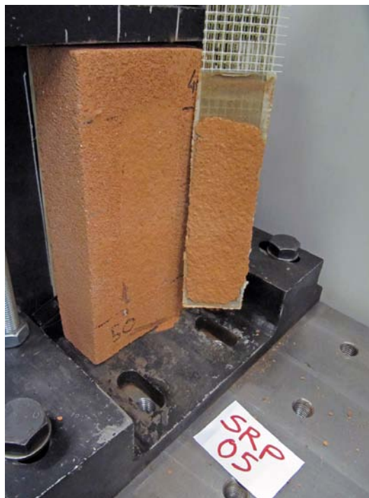
Figura 60: Campione SL-Steel-05: campione dopo la rottura.
