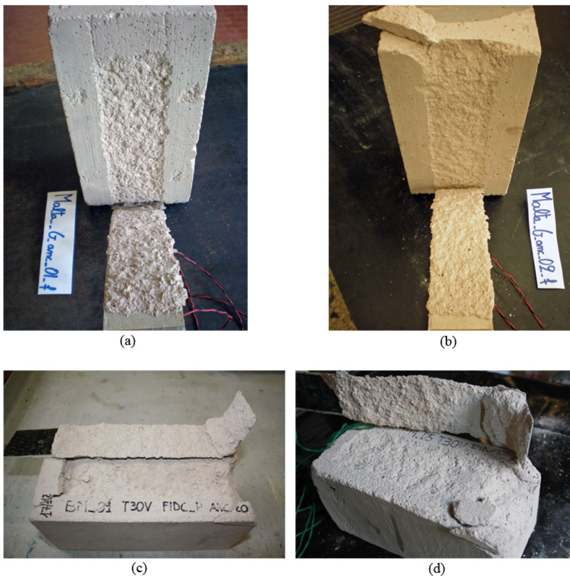
Figura 5.35: Prove di adesione su blocchi di malta: esempi di rotture riscontrate.
