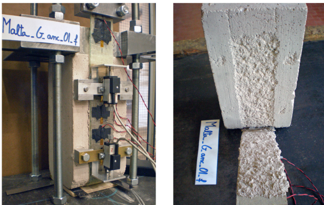
Figura 63: Campione Malta-G-01f: campione dopo la rottura.
