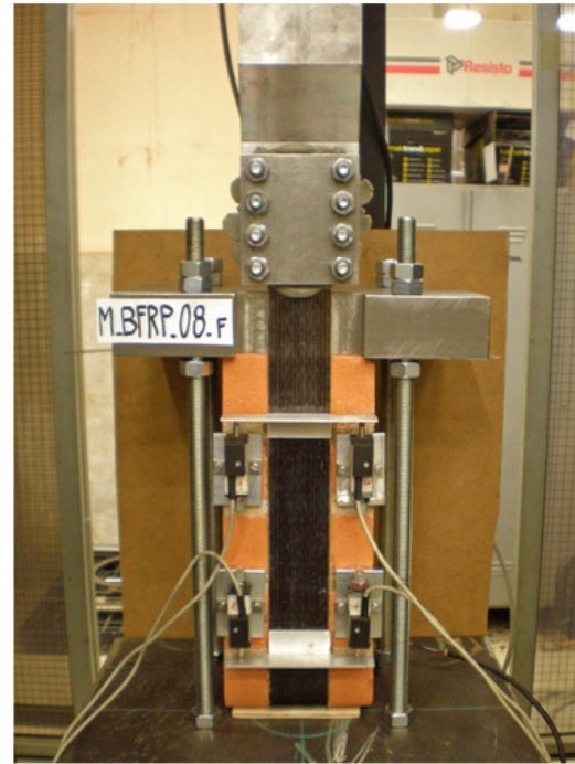
Figura 124: Campione M-BFRP-anc-08f: geometria del provino e apparato di prova.
