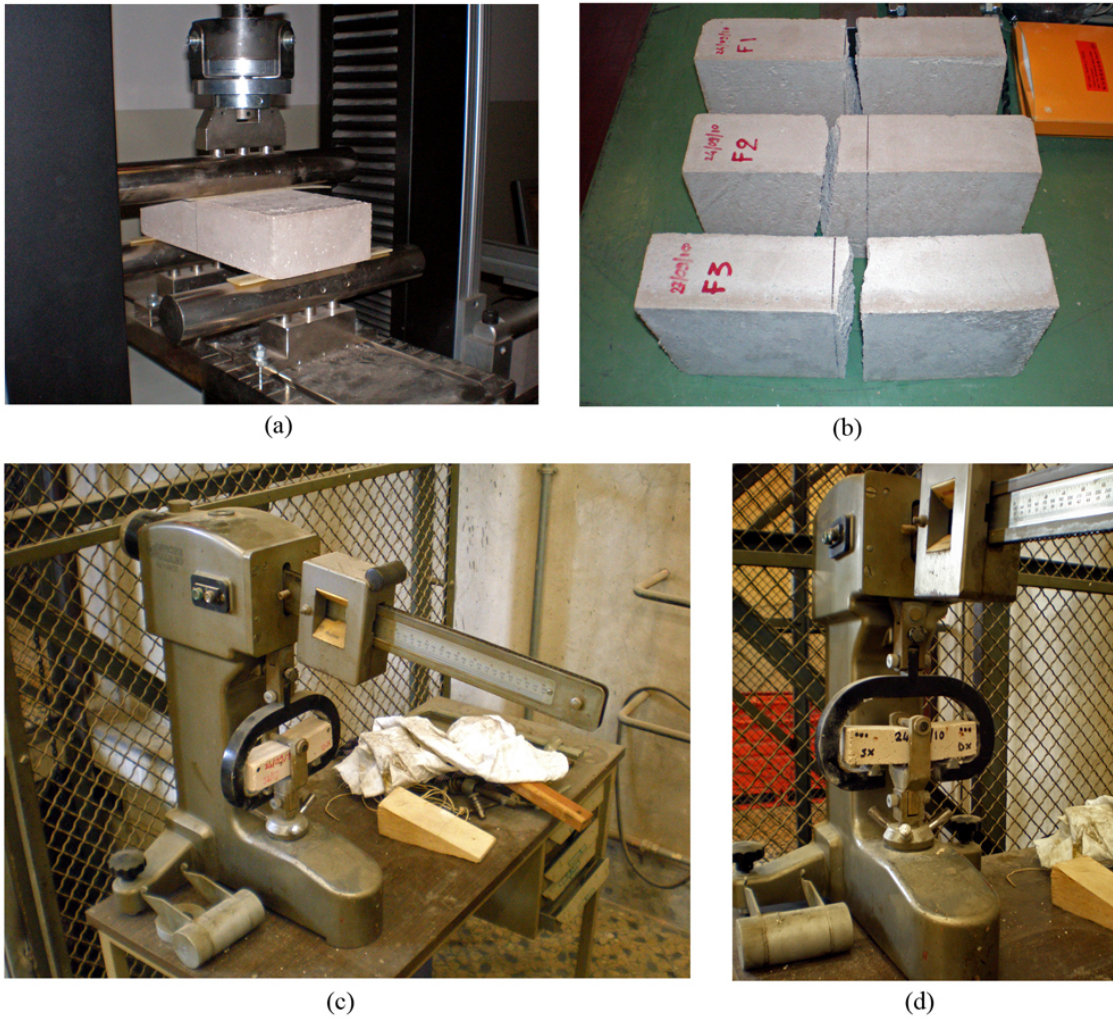
Figura 4.10: Prova a flessione: (a) set-up di prova, (b) provini dopo la rottura, (c) macchina “Officine Galileo”, (d) posizionamento provino.
