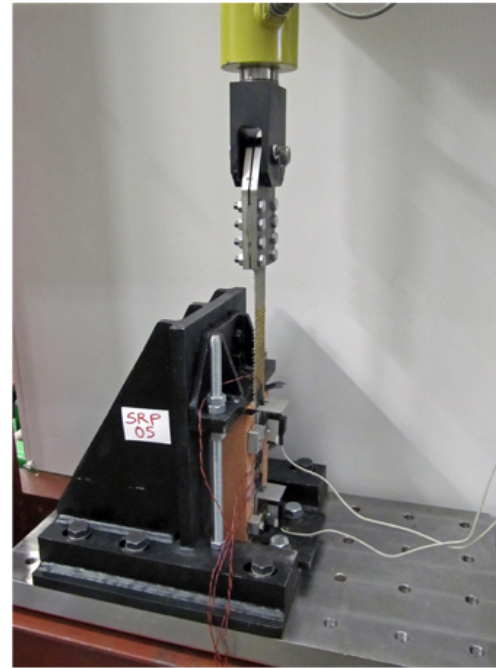
Figura 58: Campione SL-Steel-05: geometria del provino e apparato di prova.
