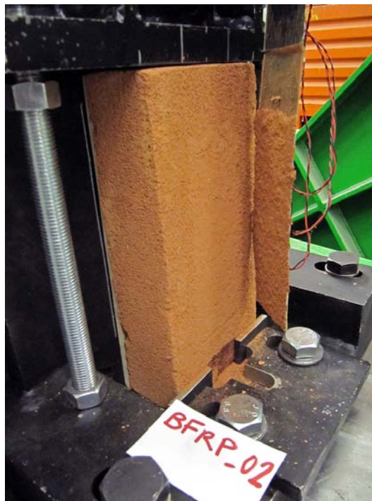
Figura 43: Campione SL-Basalt-02: campione dopo la rottura.
