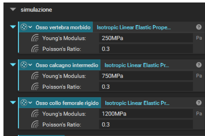
Figura 37. Comando nTop attraverso cui vengono generati tre diversi materiali, ciascuno indicante una diversa tipologia ossea in base alla sede anatomica.
