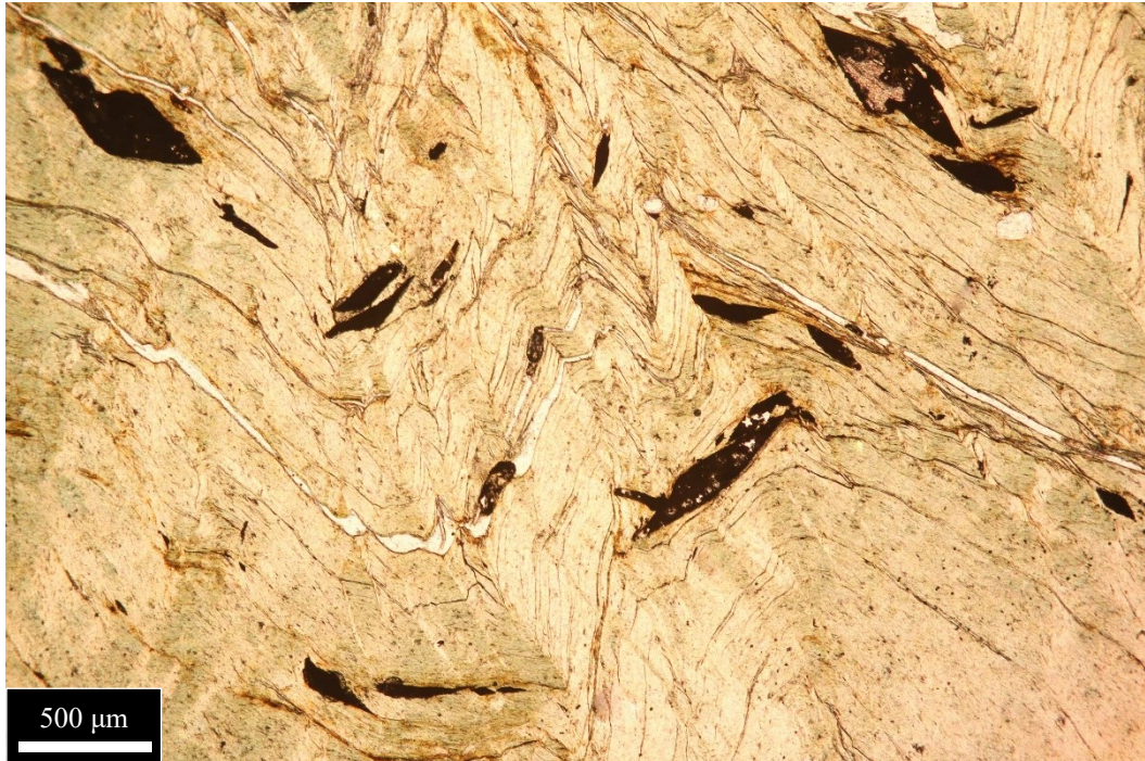
Figura 5.9.2 – Struttura a sottili letti che caratterizza questi cloritoscisti, con una scistosità ben marcata e crenulata. I cristalli di titanite qui appaiono quasi completamente sostituiti da rutilo. Ingrandimento 5X, sezione CB44.
