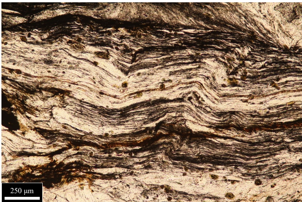
Figura 5.1.4 – Abbondanza di cristalli di tormalina associata ai livelli micacei caratterizzati da una fitta scistosità. Ingrandimento 10X, sezione CB53.
