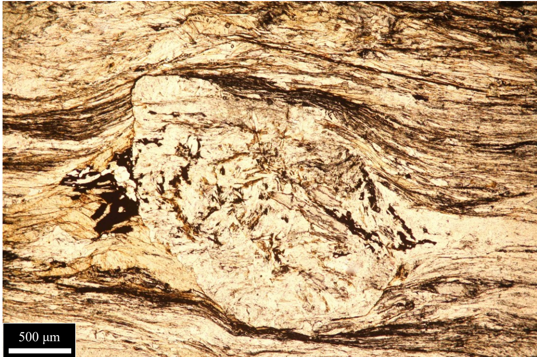
Figura 5.1.3 – Granato avvolto dalla scistosità principale S_2 e completamente sostituito da sericite. Si distinguono inclusi due cristalli allungati di cloritoide. Ingrandimento 5X, sezione CB07.
