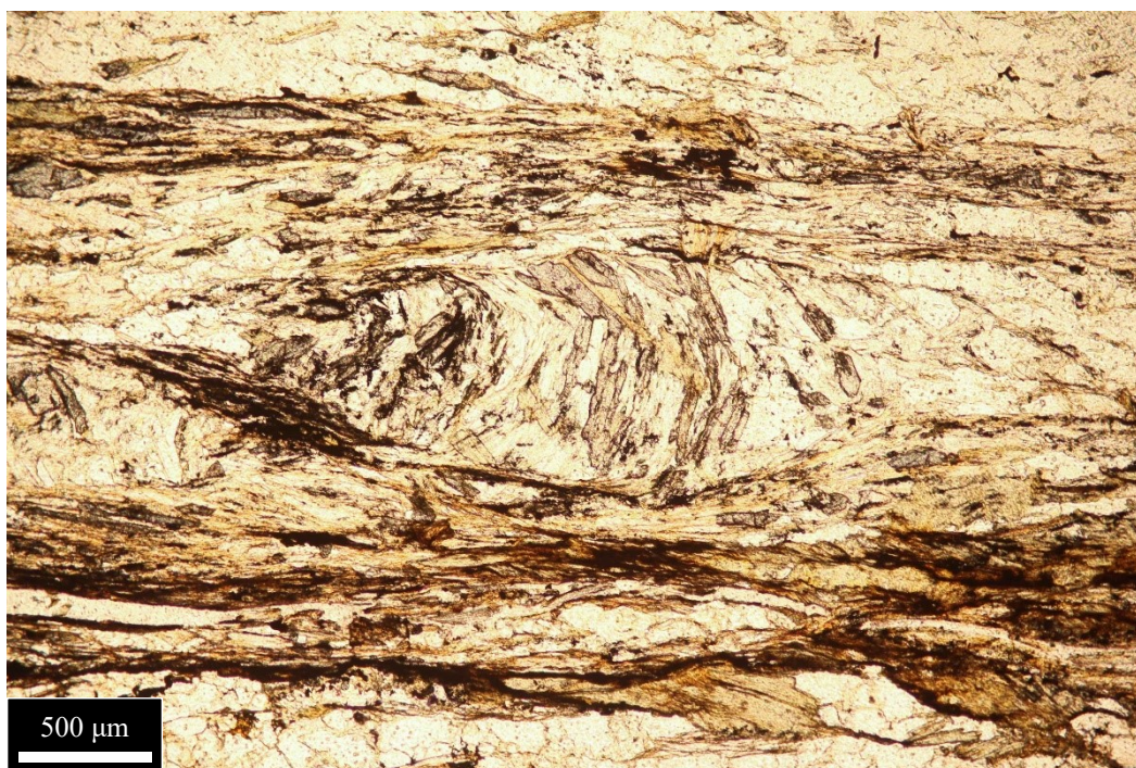
Figura 5.1.2 – Cristalli di cloritoide definiscono una piega relitta sradicata appartenente alla scistosità S_1 . Appena sotto, altri cristalli di cloritoide seguono la scistosità principale S_2 . Ingrandimento 5X, sezione CB06.
