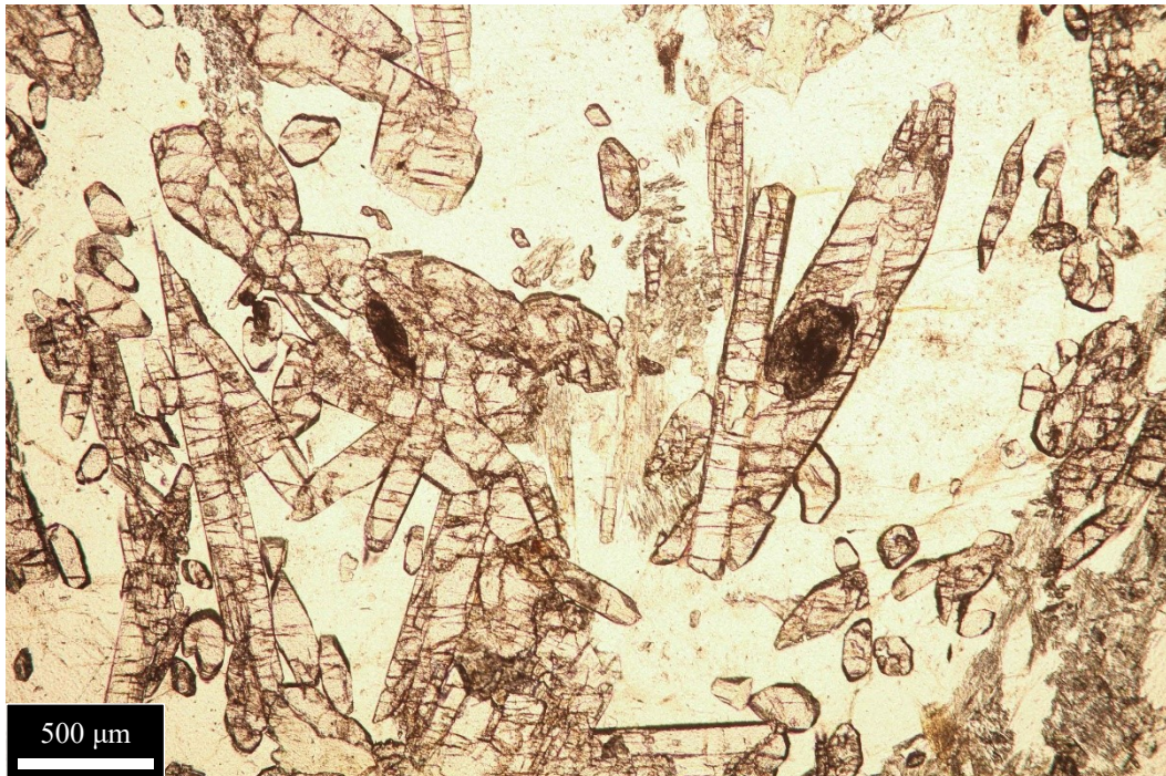
Figura 5.10.4 – Numerosi epidoti immersi nella matrice albitica. Uno di questi include al nucleo un cristallo di titanite. Ingrandimento 5X, sezione CB14.
