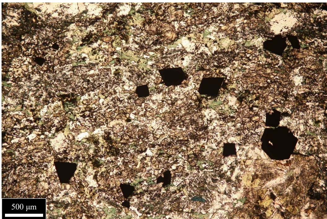
Figura 5.7.3 – Si osserva la dimensione minuta dei cristalli delle metabasiti CB26-CB27-CB29. I minerali di dimensione minuta sembrano sovrainporsi alla sottostante classica struttura prasinitica ormai quasi irricognoscibile. Tuttavia, si possono apprezzare abbondanti opachi idiomorfi. Ingrandimento 5X, sezione CB26.
