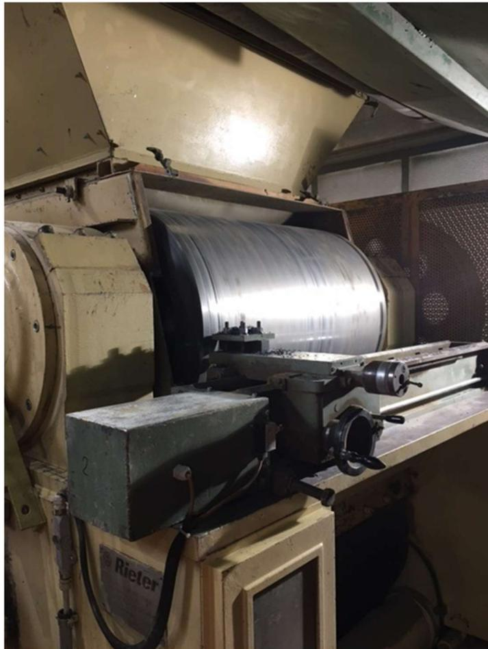
*Figura 1 - Rullo del laminatoio durante la rettifica - Wienerberger Feltre*
