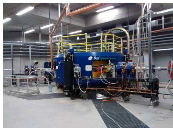
Figura 2.1 –A sinistra una planimetria di parte del piano interrato del laboratorio SPES: al centro è visibile il ciclotrone da cui dipartono due linee di trasporto di fascio. A destra una fotografia del ciclotrone scattata in occasione della visita organizzata per l'edizione 2016 della conferenza UCANS: Union of Compact Accelerator Drive Neutron Sources (Legnaro).
