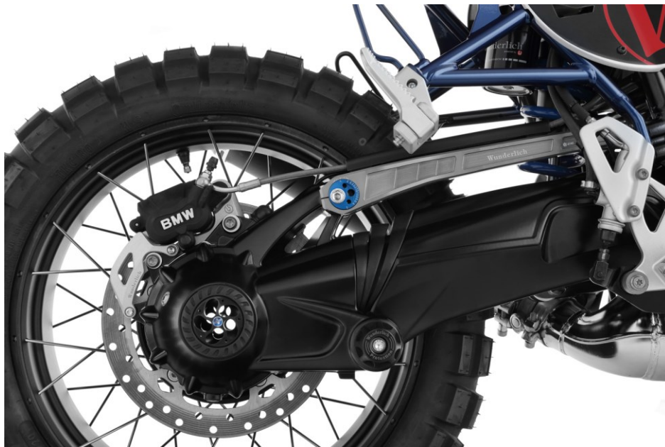
In figura: a sx forcellone "Paralever" di BMW nineT Scrambler, a dx forcellone "Carc" di Moto Guzzi Bellagio
