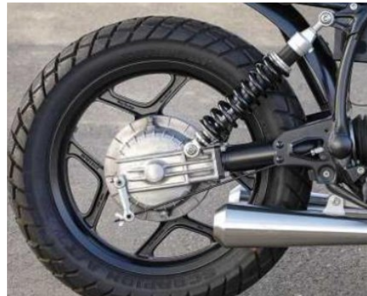
In figura: “Monolever” di BMW R80, utilizzato prima dell’introduzione del paralever.
