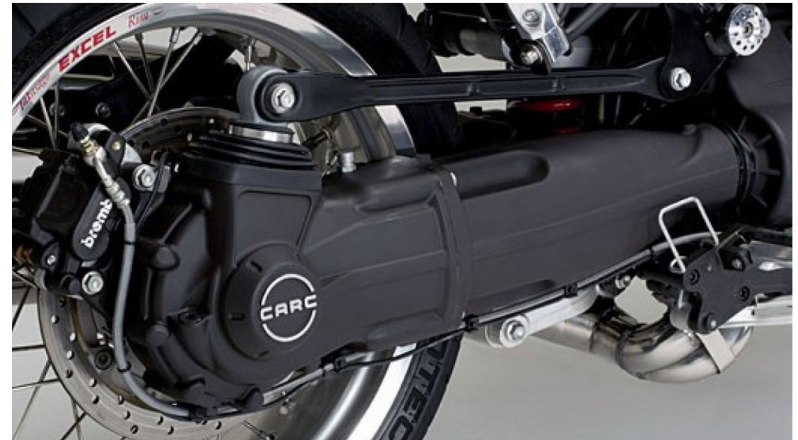
In figura: a sx forcellone "Paralever" di BMW nineT Scrambler, a dx forcellone "Carc" di Moto Guzzi Bellagio
