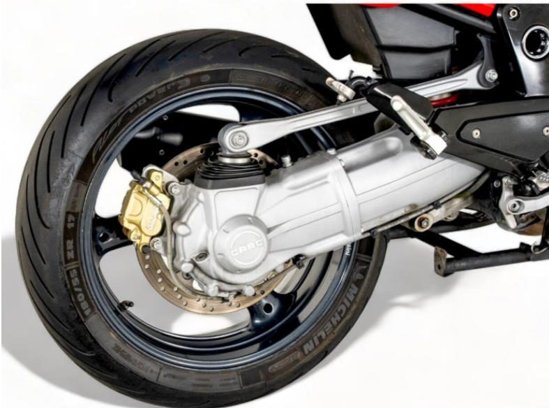
In figura: unica versione di “Carc” Moto Guzzi, introdotta nel 2005.
