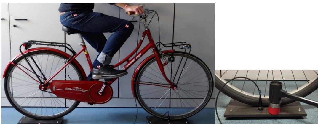
Fig. 5.1 - Una delle due biciclette (modello Coventry) testate e il martello strumentato usato per i test
