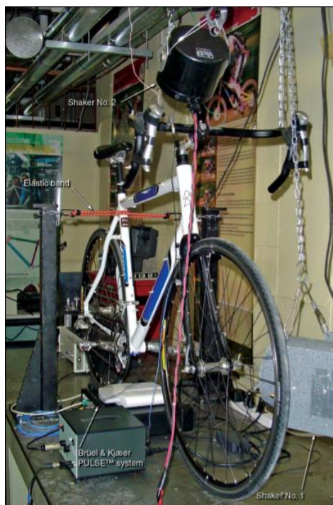
Fig. 3.3 Apparato sperimentale utilizzato (MIMO in figura) [8]
