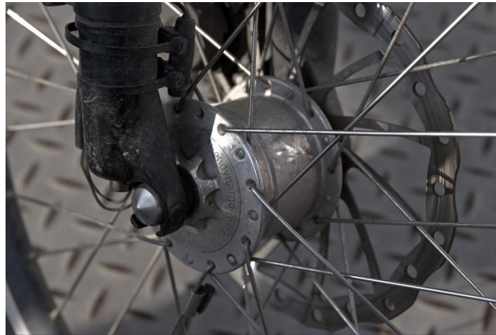
Fig. 4.14 - Esempio classico di un modello di Hub Dynamo della Schmidt-Nabendynamo [23]
