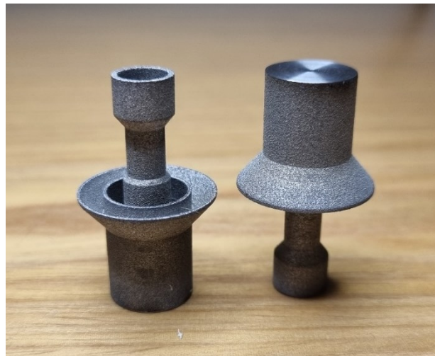
Figura 2.7.4 Catodi poco prima di essere inseriti all'interno della macchina di prova per i test in alto vuoto e ad alta temperatura sotto carico elettrico.
