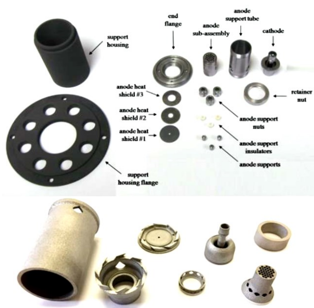
Figura 2.5.1.1 Immagine che evidenzia la profonda differenza sia nel numero di componenti che va a comporre la sorgente completa, sia a evidenziare l'irrealizzabilità di certe geometrie con una tecnologia tradizionale nel caso della sorgente Additive
