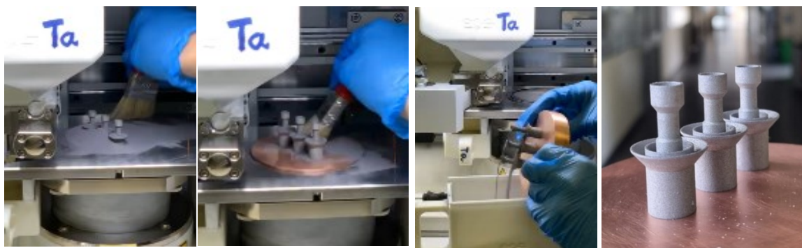
Figura 2.7.2 Serie di foto con le quattro fasi di estrazione dei catodi saldati alla piattaforma di costruzione in rame
