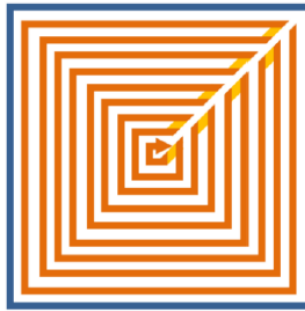
Figura 2.3.2.7 Tipologia Contour per la scansione laser [17]
