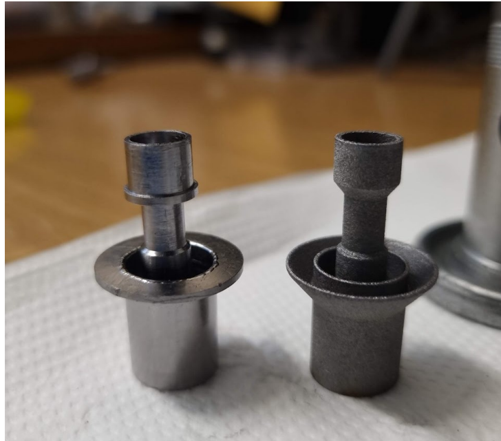
Figura 4.4.2.1 A sinistra il catodo Standard, mentre a destra il catodo Additive
