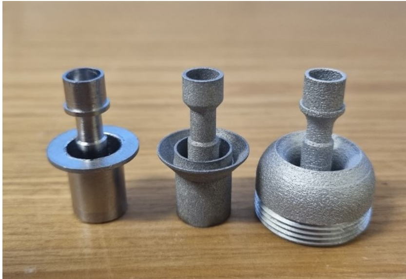
Figura 5.3.1.1 Nell'immagine sono rappresentati: a sinistra il modello standard di catodo, al centro il modello additive studiato in questa tesi, a destra il modello di catodo rielaborato per la geometria completamente additive della sorgente.
