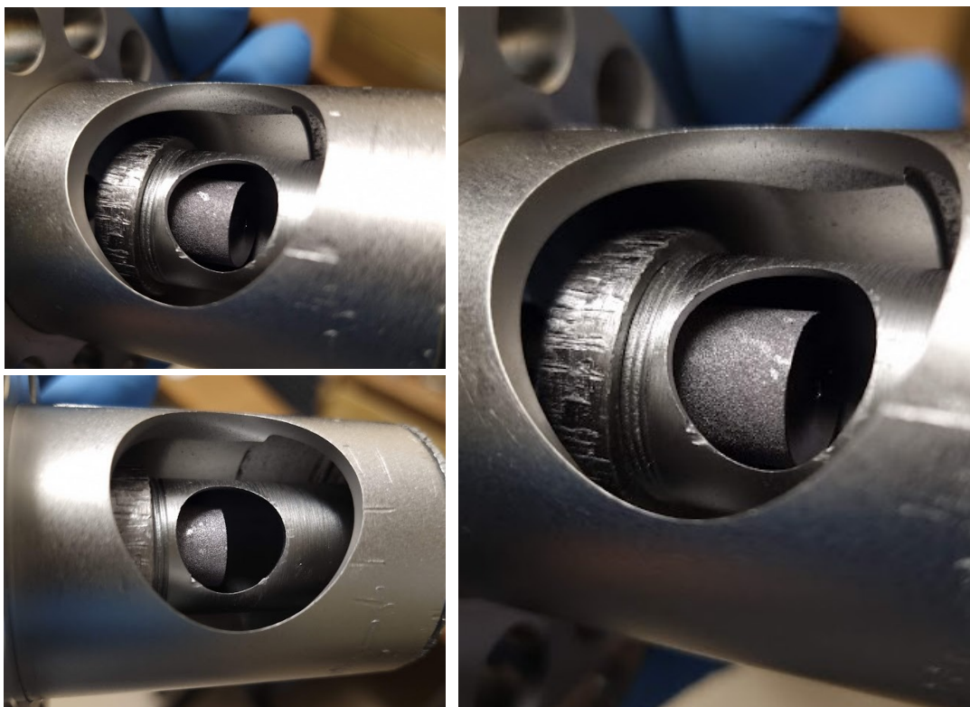
Figura 4.4.4.1 Alcune immagini in cui sono ben visibili i grani ricristallizzati sul catodo Additive dopo poche ore di test Endurance
