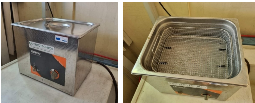
Figura 4.3.2.1 Lavatrice ad ultrasuoni utilizzata per la pulizia prima dell'inserimento nella camera a vuoto
