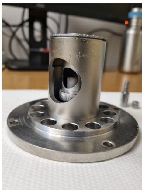
Figura 4.4.2.4 Sorgente montata completamente per quanto riguarda i componenti interni, la transfer line in genere viene montata a parte
