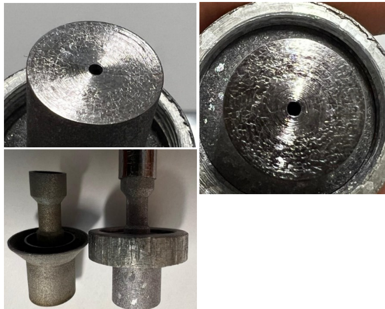
Figura 4.6.2 Alcune immagini in cui è ben visibile l'effetto di ricristallizzazione sulla faccia frontale e laterale del catodo. Nell'immagine in basso a sinistra si può notare la differenza tra catodo prima e dopo il riscaldamento, sono evidenti i cristalli nel catodo riscaldato.
