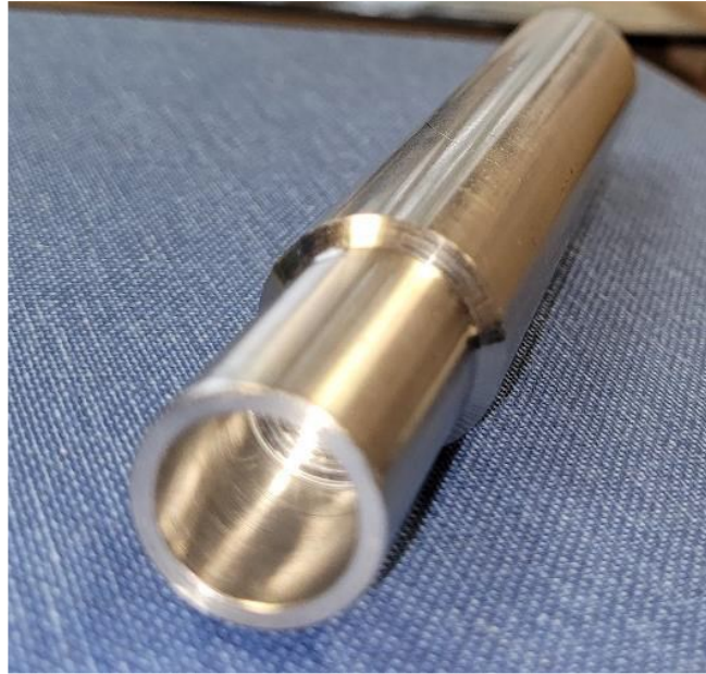
Figura 5.2.2.1 Tool di montaggio della sorgente con il metodo studiato presso INFN nel 2015
