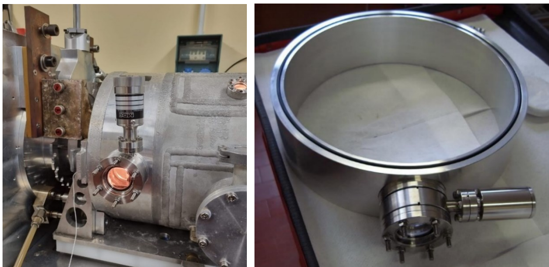
Figura 4.2.2.3 Componente di transizione, nella foto a sinistra è montato e collegato alla camera a vuoto ed è in evidenza anche la funzione della finestra di osservazione che permette di visionare all'interno il comportamento e la temperatura dei componenti. A destra nella seconda foto invece c'è il componente smontato, in risalto soprattutto la guarnizione introdotta precedentemente riguardo i limiti termici.
