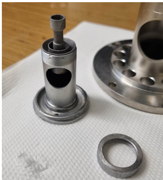
Figura 4.4.2.3 Catodo inserito all'interno della discharging chamber, in basso a destra nella foto si vede la ghiera di fissaggio
