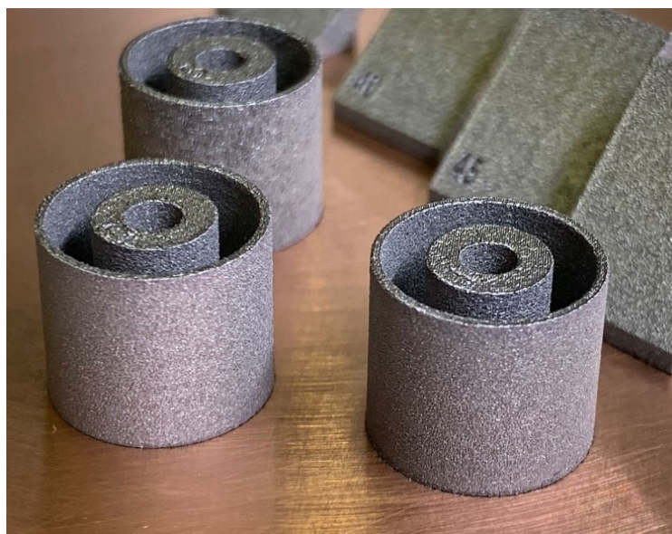
Figura 2.6.1.1 Foto dei tre doppi cilindri, il loro scopo è valutare la qualità del risultato a livello superficiale con tre distinte strategie di produzione.
