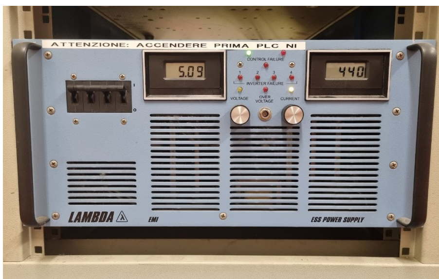
Figura 4.2.3.1 Trasformatore usato nel laboratorio per l'erogazione della corrente riscaldante. Come evidente nell'immagine, è possibile leggere la corrente in Ampere (a destra) e la tensione in Volt (a sinistra). È possibile regolare tali valori con le due manopole, quella di sinistra regola la tensione e quella di destra regola la corrente. Tutto a sinistra è visibile anche l'interruttore generale del trasformatore.
