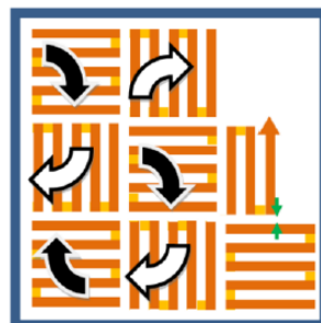
Figura 2.3.2.6 Tipologia chess per la scansione laser [17]
