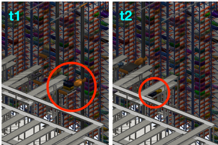
Figura 6.8: Modello n.2: scarico simultaneo di due UdC da un miniload : inizio dello scarico all'istante t1; scarico ultimato all'istante t2.
