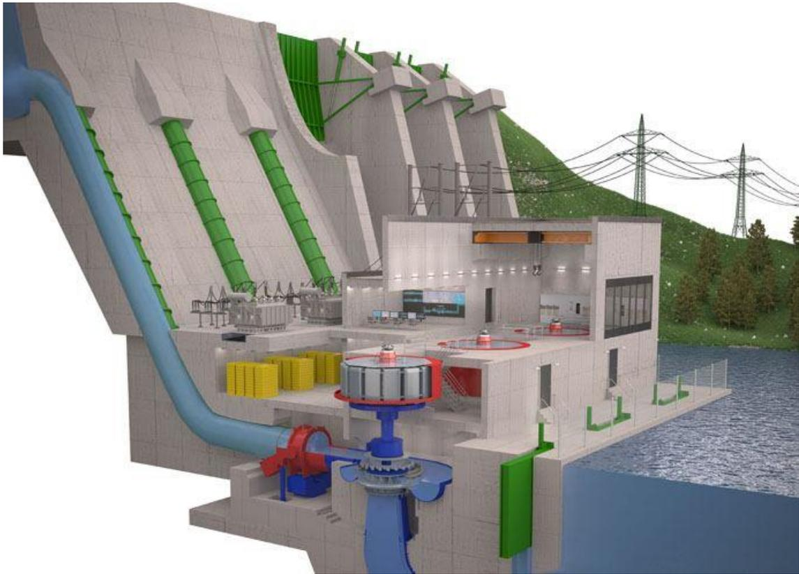
Figura 6.11 Esempio di un impianto progettato da Andritz Hydro [40]
