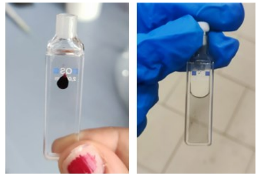
Figura 21: Cuvetta da 2 mm usata per lo spettro UV-Vis a sx e per lo spettro Raman a dx.
