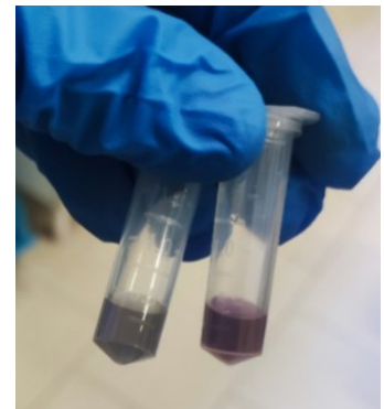
Figura 27: Colorazione dopo l'aggiunta del PBS a una soluzione senza DNA (sx) e una con (dx).
