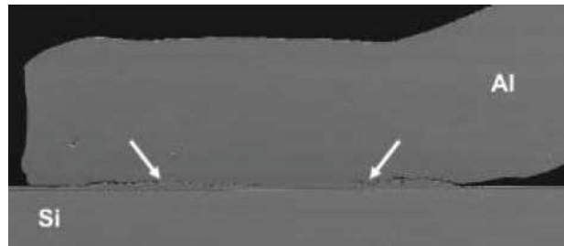
Figura 10. Cricche innescanti il bond wire liftoff [25]
