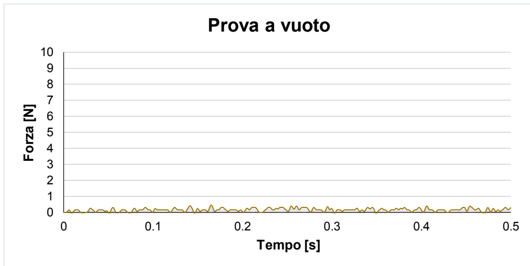
Figura 4.21: Forma tipica del grafico risultante di una prova a vuoto.
