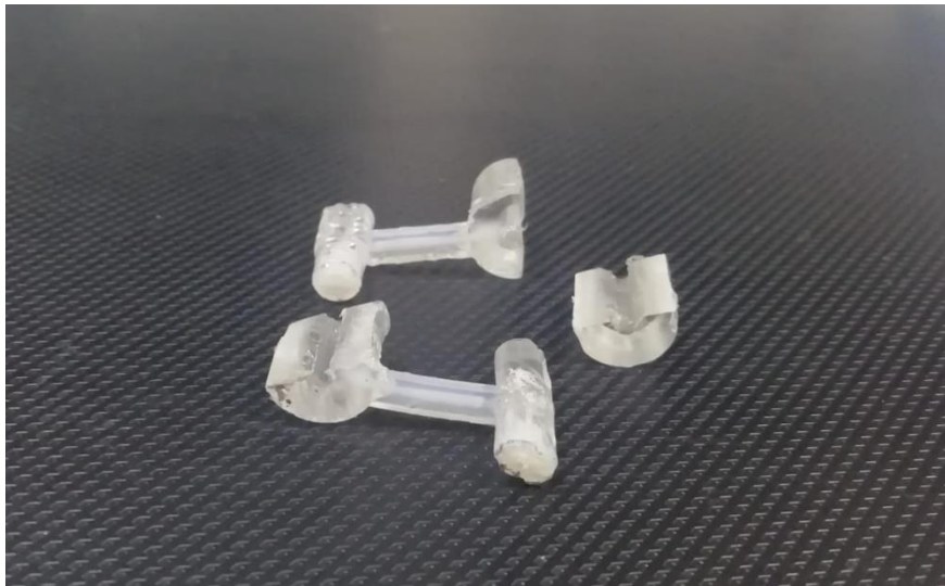
Figura 4.16: Componenti stampati sezionati lungo diversi piani.
