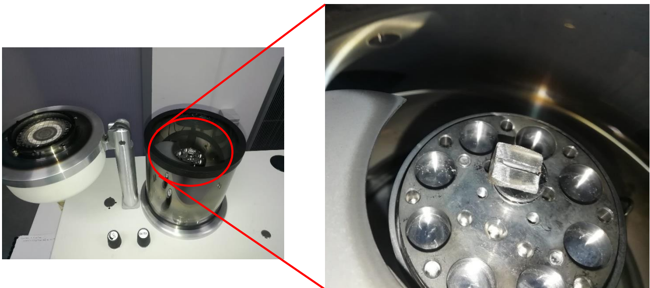
Figura 4.17: Componente sezionato che ha subito il processo di sputtering.
