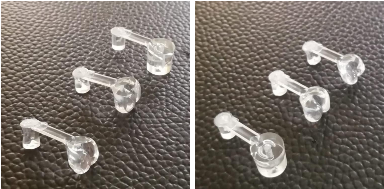
Figura 5.16: Short shot stampati per verificare la validità della simulazione numerica
