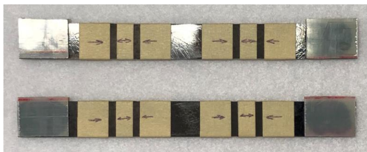
FIG.8.48 Disposizione del nastro carta sui provini per cablaggio a 4 elettrodi.
