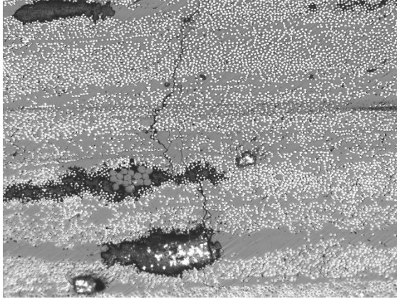
FIG.9.14 Micrografia 100x: prima cricca esaminata. FIG.9.15 Micrografia 50x: seconda cricca esaminata.
