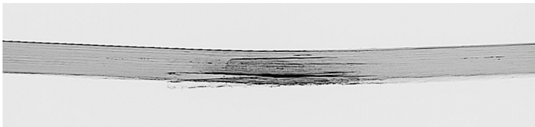
FIG.9.30 Radiografia laterale del campione danneggiato, osservazione della zona delaminata.
