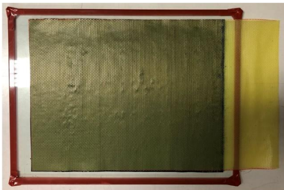
FIG.8.4 Posizionamento del primo ply .
