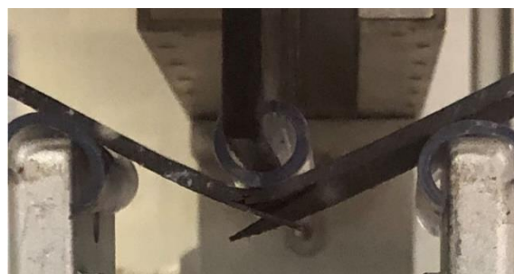
FIG.9.28 Immagine del campione sotto sforzo al termine della quarta rampa di carico.
