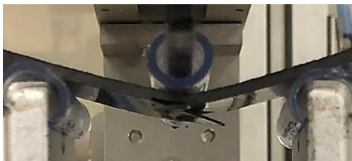
FIG.9.37 Immagine del campione sotto sforzo, al termine della seconda rampa di carico.
