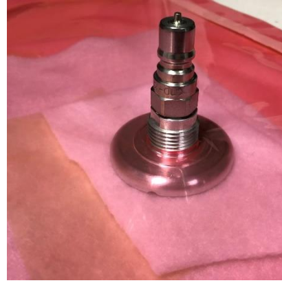
FIG.8.12 Foratura del sacco per garantire la fuoriuscita della valvola.
