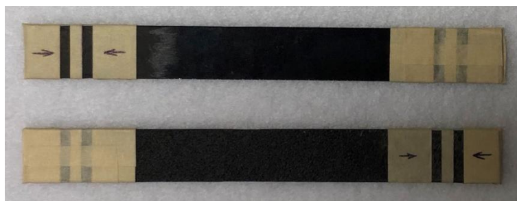
FIG.8.47 Disposizione del nastro carta sui provini per cablaggio a 4 elettrodi opposti.
