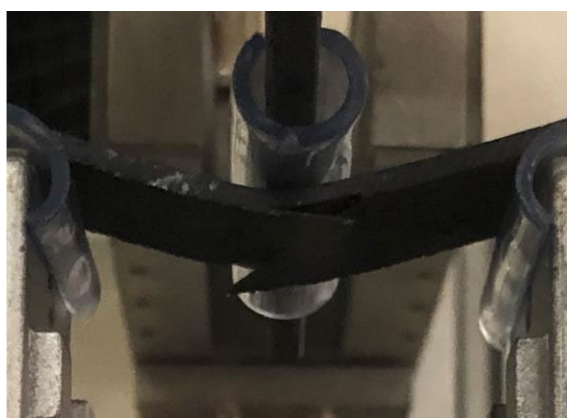
FIG.9.27 Immagine del campione sotto sforzo al termine della seconda rampa di carico.
