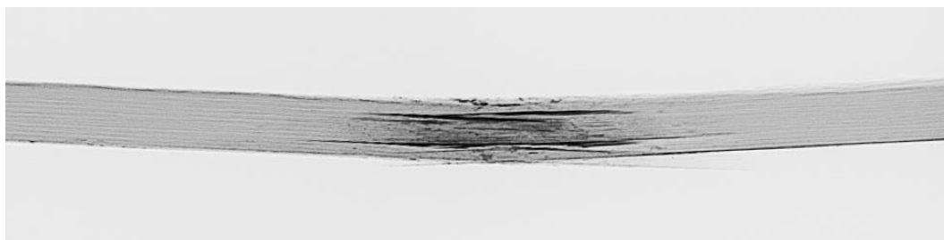
FIG.9.42 Radiografia laterale del campione danneggiato, osservazione della zona delaminata.
