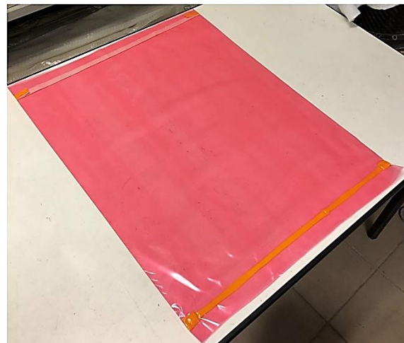
FIG.8.8 Sigillatura parziale e totale delle due estremità del sacco da vuoto.
