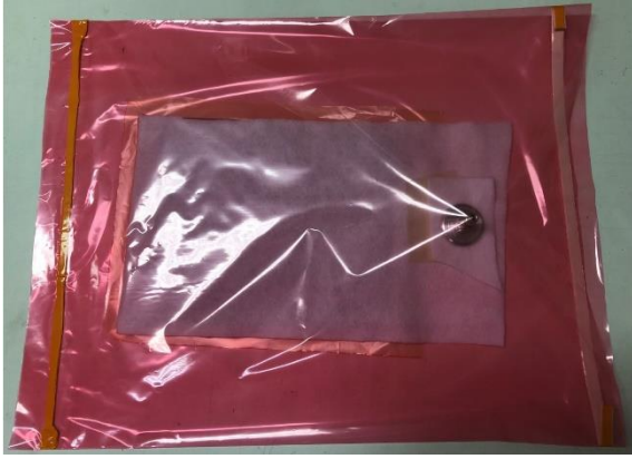
FIG.8.11 Posizionamento dello stampo all'interno del sacco da vuoto.
