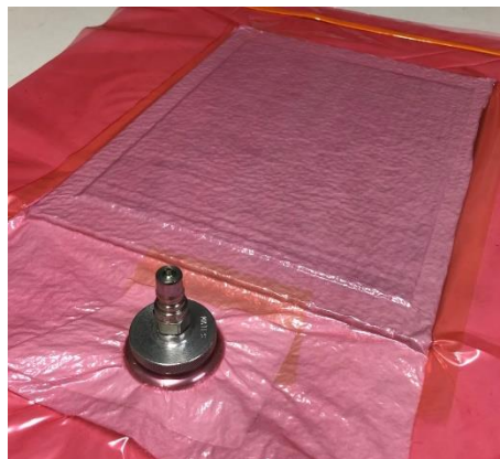
FIG.8.14 Scollegamento del compressore da vuoto e verifica tenuta.
