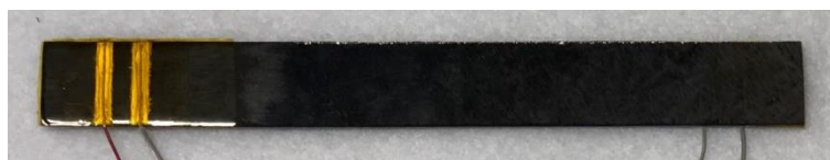
FIG.8.50 Disposizione degli elettrodi e nastro kapton sul provino per cablaggio a 4 elettrodi opposti.
