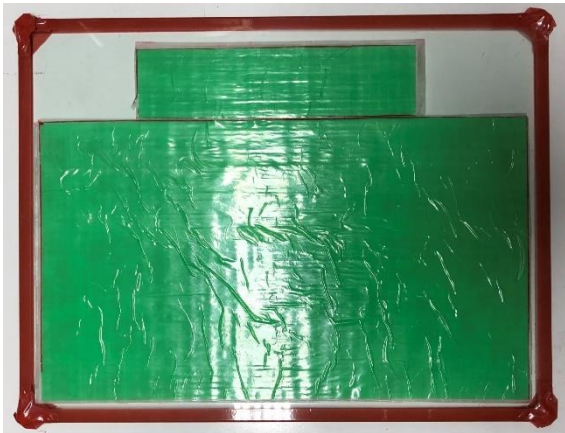
FIG.8.52 Laminato [0/90]_s pre-autoclave.
