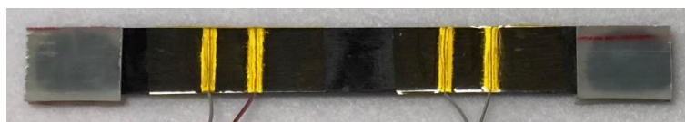
FIG.8.51 Disposizione degli elettrodi e nastro kapton sul provino per cablaggio a 4 elettrodi.
