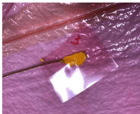
FIG.8.17 Dettaglio di una termocoppia.
