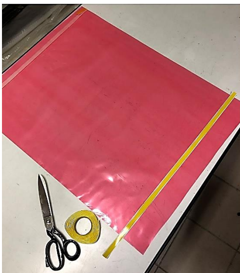
FIG.8.7 Preparazione del sacco da vuoto.
