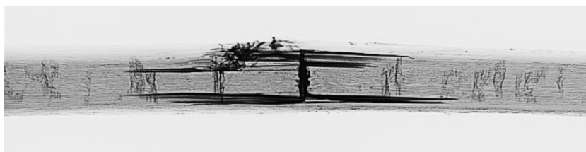
FIG.10.26 Radiografia laterale del campione danneggiato, osservazione della zona delaminata.
