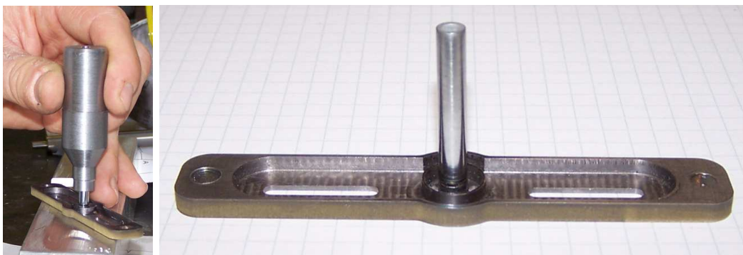
Figura 65: fase di montaggio della hot cavity sul supporto e risultato finale prima del riscaldamento
