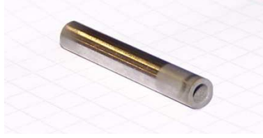
Figura 62: risultato della foratura ad elettroerosione utilizzando il dielettrico "VITOL"
