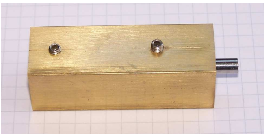
Figura 59: barretta di renio inserita nel supporto in ottone per poter eseguire le lavorazioni
