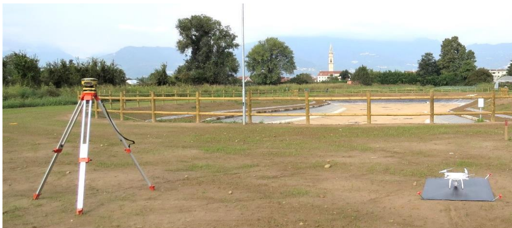
Figura 17: Dispositivi utilizzati per il rilievo topografico ad alta risoluzione del bacino di ritenzione vuoto (sullo sfondo), (Report terzo anno)
