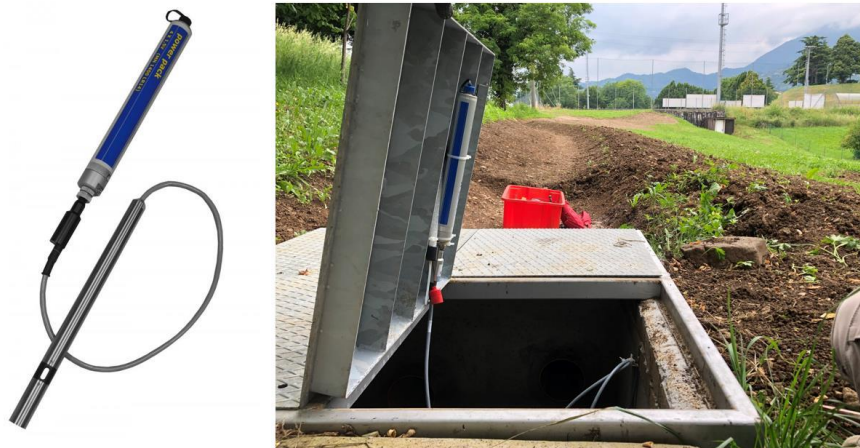
Figura 15: A sinistra, Il trasduttore di pressione SEBA Dipper-PT utilizzato per monitorare la portata sulla cresta dello stramazzo sulla sinistra. A destra, Di seguito è presente una foto che mostra la posizione dello strumento di misurazione del livello nel pozzetto, (Report terzo anno)
