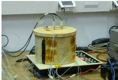
Figura 4.7: Piano in legno compensato e pentola rivestita in legno
