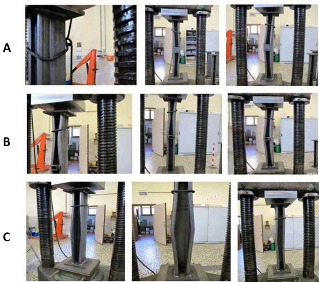
Figura 33: documentazione fotografica prove MT120x140x30x5.0 H=1000mm (S500MC)
