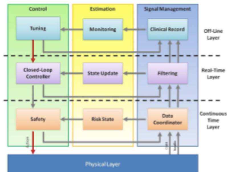
Figura 3.9: Architettura modulare per il pancreas artificiale
